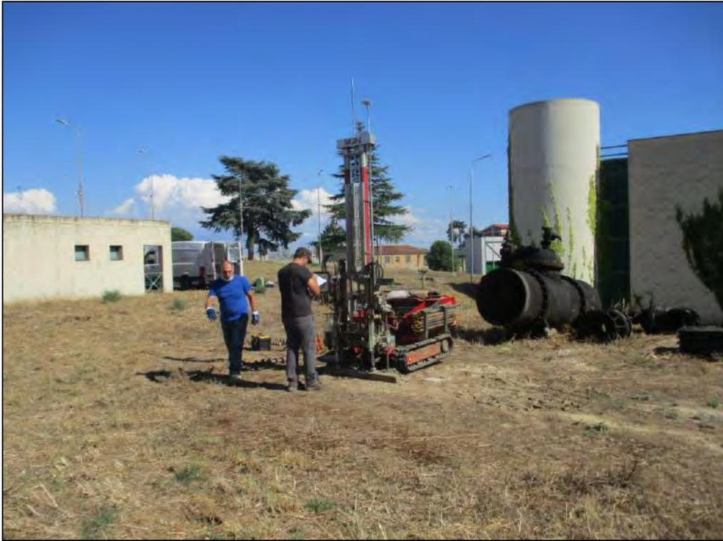
*Esecuzione prova penetrometrica dinamica DPSH12*
