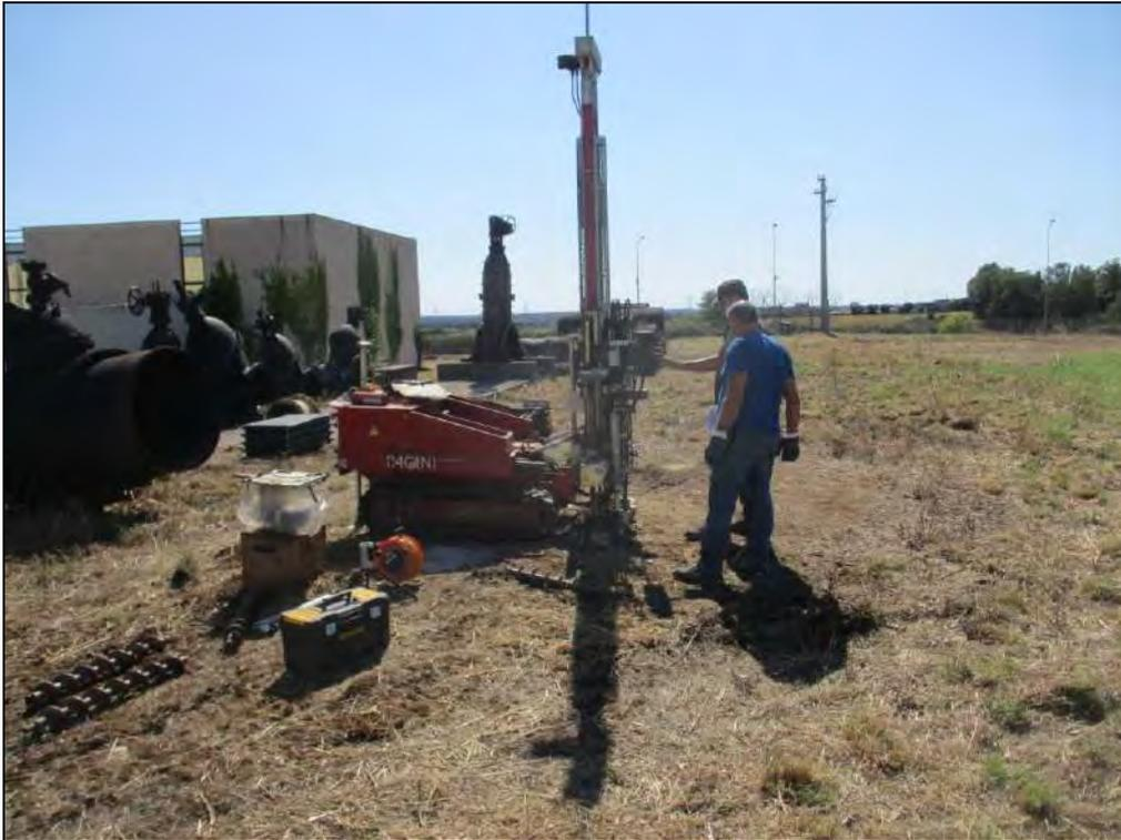
*Esecuzione prova penetrometrica statica CPTU12*
