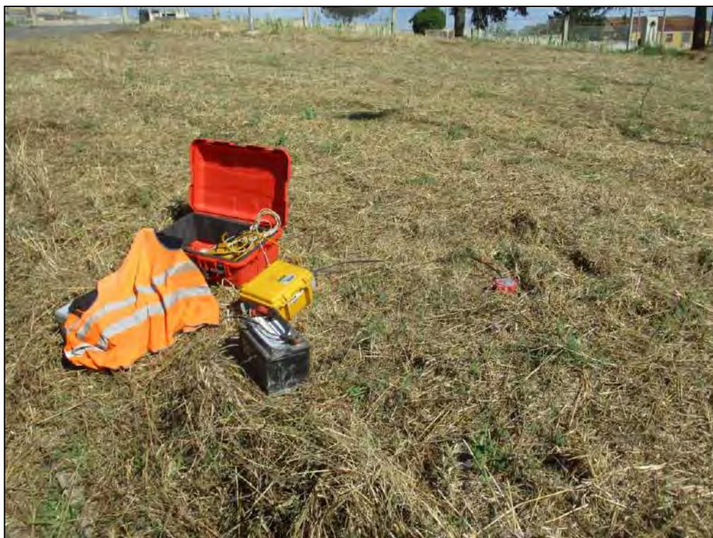
*Esecuzione prova sismica passiva HVSR12*
