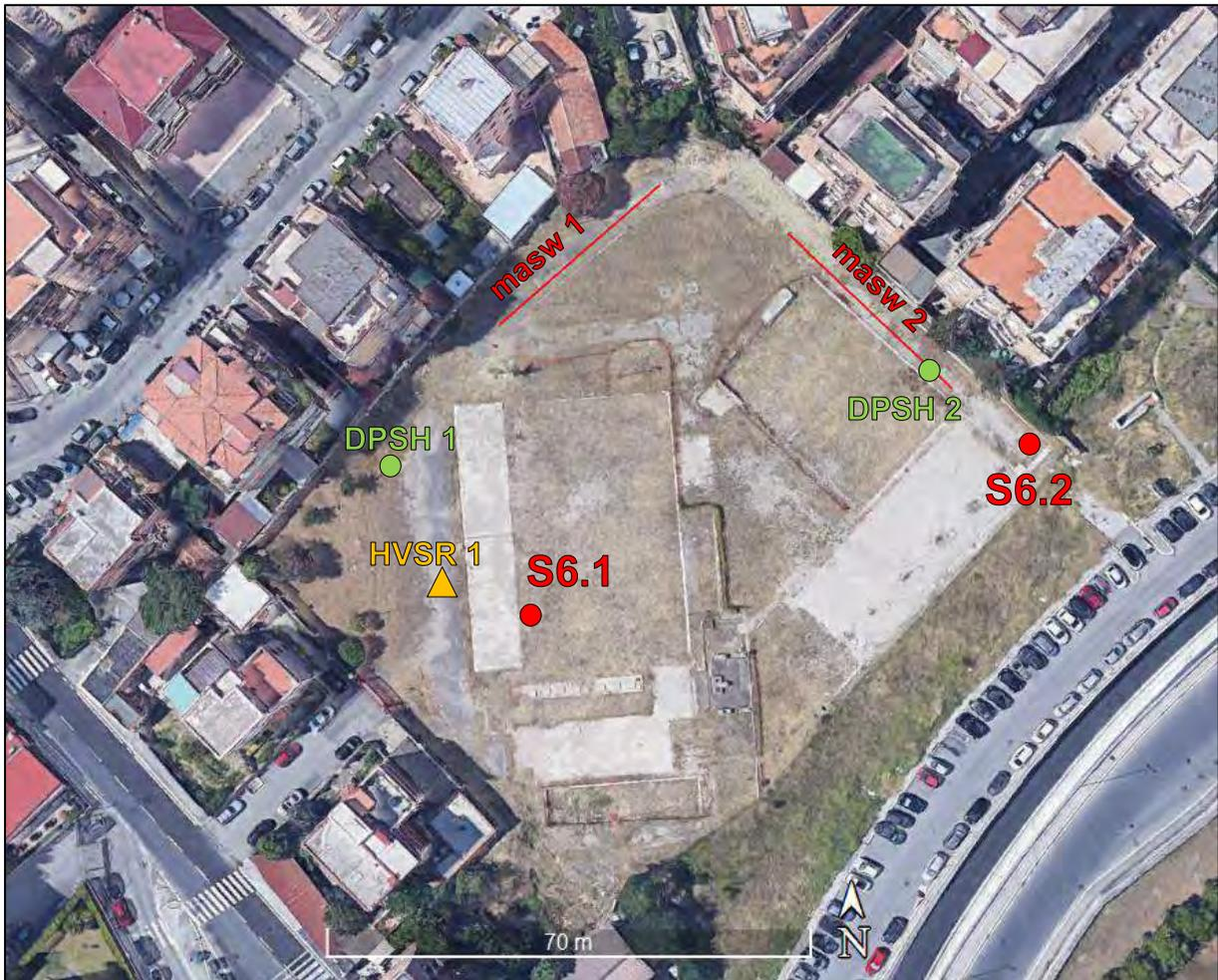
● Sondaggio geognostico, down-hole/piezometro
