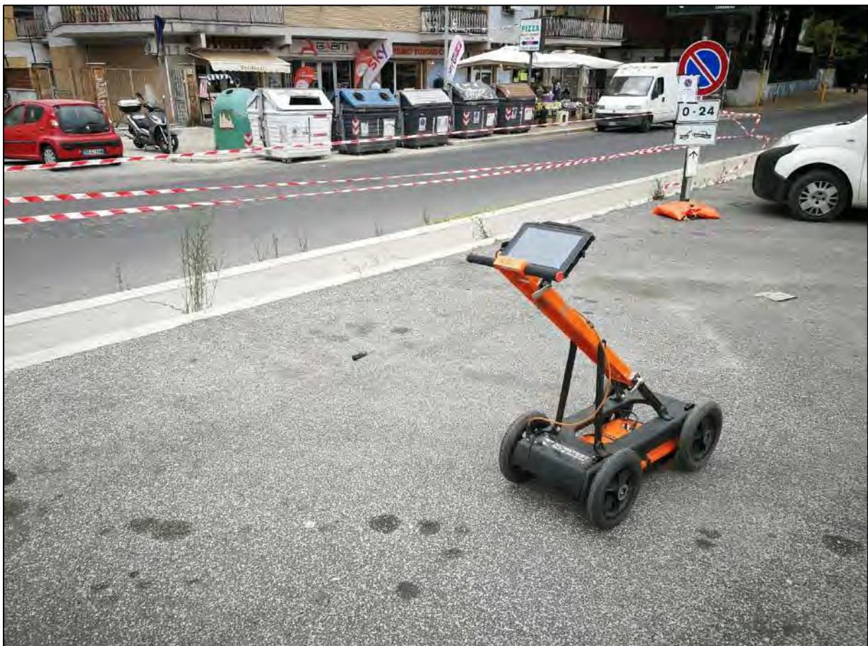
*GPR VIY5-37 utilizzato nel rilievo georadar.*
