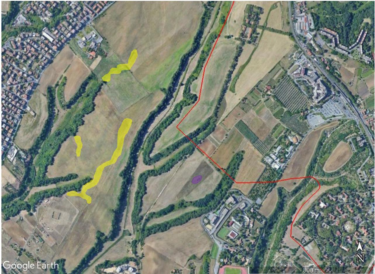
Fig. 11. Opere in progetto, località Marmo Nuovo. Foto satellitare googleearth del febbraio 2020. In evidenza in rosso il tracciato delle opere; in giallo le anomalie riferibili a paleoalvei sepolti. In viola, al centro dell'immagine, l'anomalia di forma ovale del diametro di 55 m. riferibile a banchi di roccia affiorante o a strutture sepolte.
