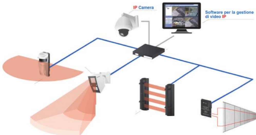
Fig. 27 Sistema di videosorveglianza e antintrusione
