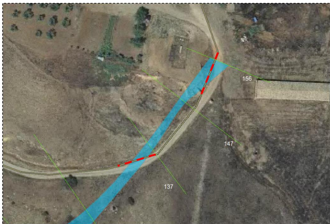
Fig. 14 Area "E Nord". Particolare del tratto di cavidotto a realizzarsi con tecnica T.O.C
