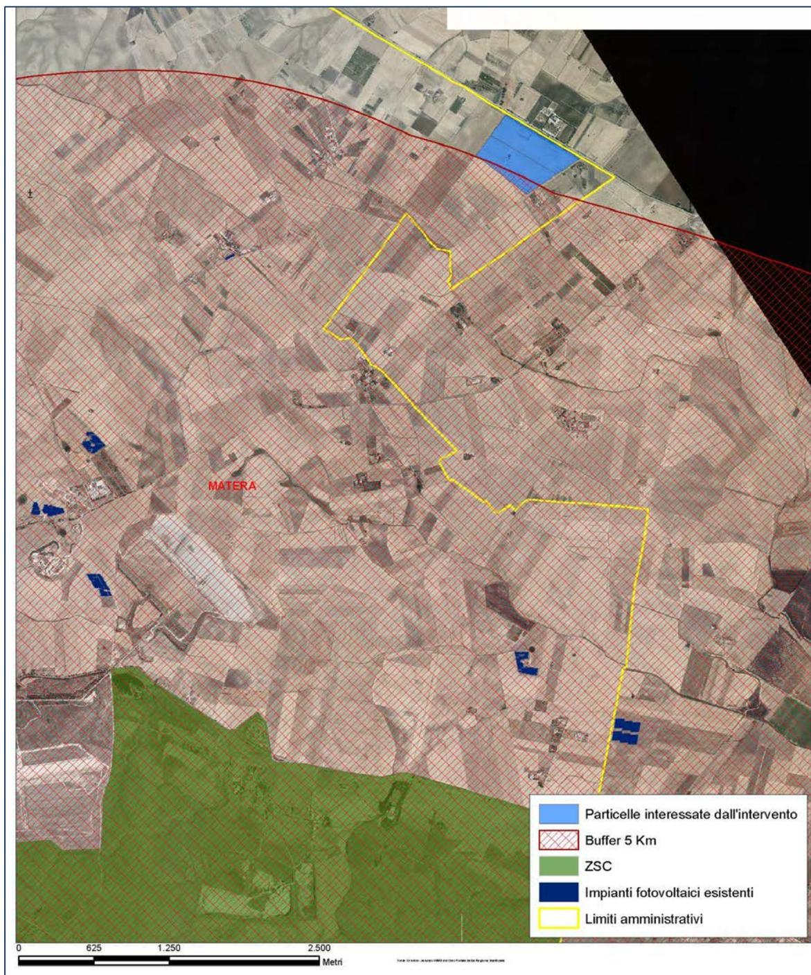
Il buffer di 5 km è stato inserito nel PRG di Matera a seguito di prescrizione regionale (Fascia di protezione delle aree SIC e ZPS “Gravina di Matera” Del C.R. Basilicata 15.02.2005 n.927). L’area buffer non presenta una regolamentazione specifica, per cui si è fatto riferimento direttamente alle Misure di tutela e Conservazione della rete Natura 2000 (estratto dalla DGR n.951/2012 e DGR n.30/2013). Analizzandone le prescrizioni si esprimono le seguenti considerazioni:
