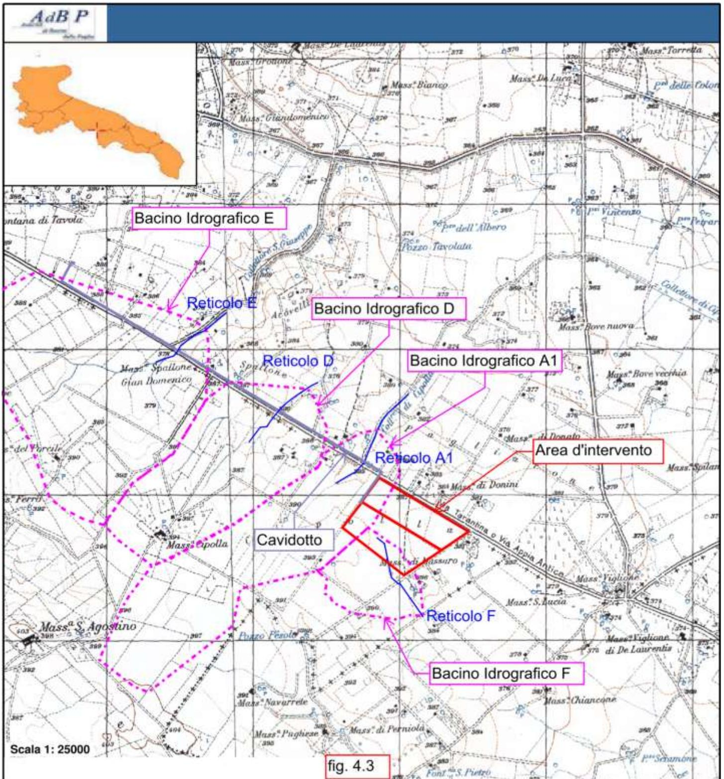
fig. 4.3 – Stralcio IGM Tavoleta II SO "Vallone della Silica" del Fg. 189, con l'indicazione dei bacini idrografici e dei reticoli oggetto di studio dell'area di interesse - Scala 1:25.000.
