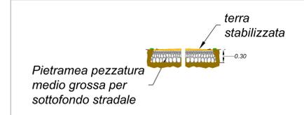
Particolare Cavidotto Perimetrale scala 1:20
