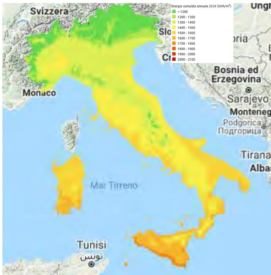
Figura 5.9 -Radiazione solare cumulata annua nel 2019 (Fonte: Elaborazione a cura di RSE su dati EUMETSAT <http://sunrise.rse-web.it/>)
