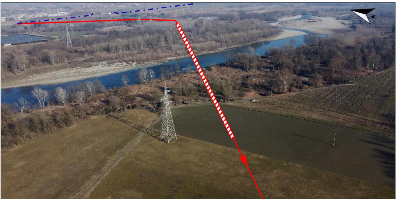
Foto 1.3.1-7 Trenchless n.1 – Attraversamento Fiume Po
