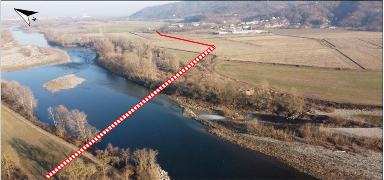
Foto 1.3.1-16 Trenchless n.3 – Attraversamento Fiume Po
