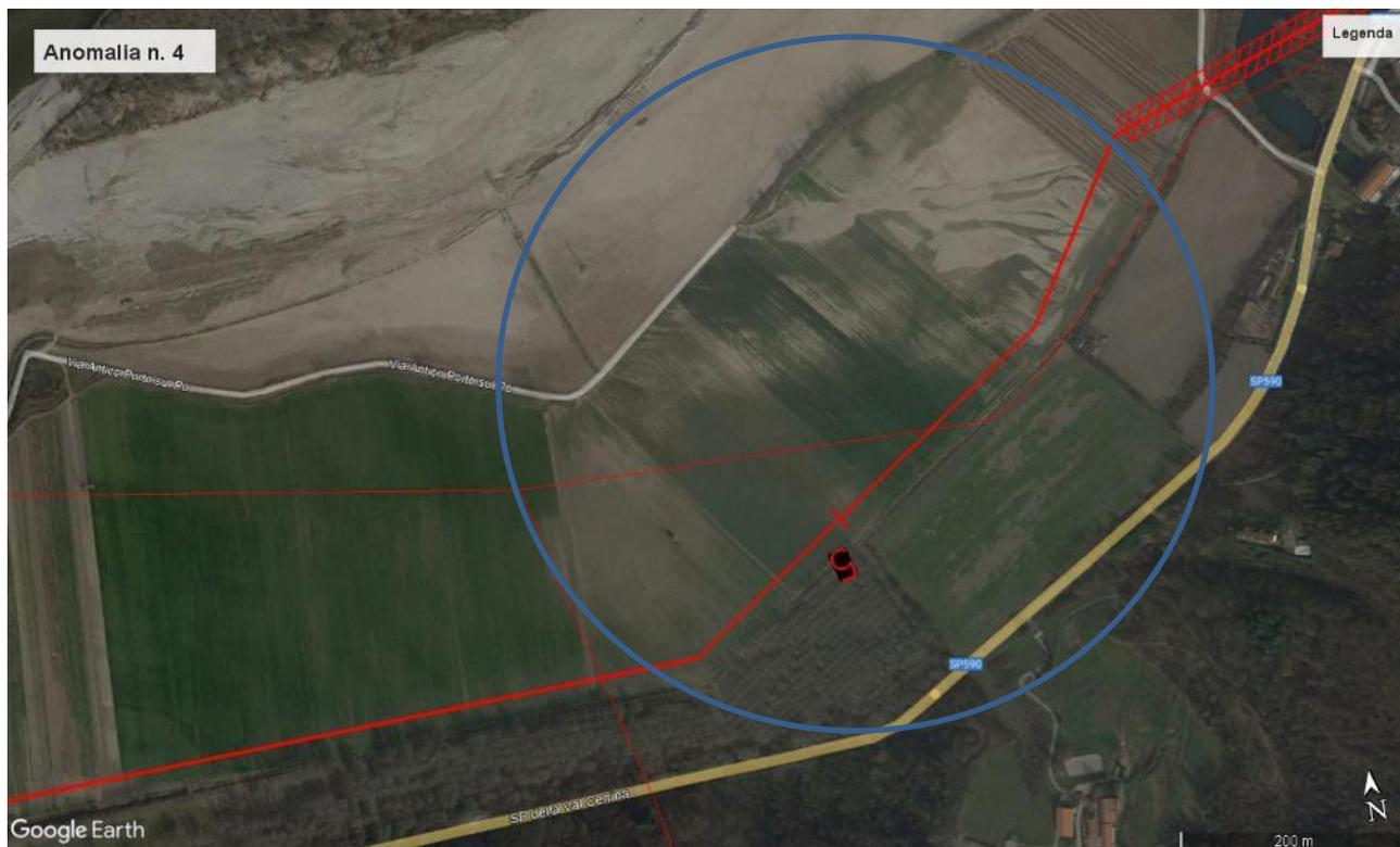
Figura 6.1-7 Anomalia n. 4 da foto satellitare (Fonte Google Earth, 3/2017) dell'area di progetto. In rosso il tracciato del metanodotto in progetto. Il cerchio blu evidenzia le tracce anomale lineari, di probabile origine naturale, legate alla presenza di ventagli di rotta.
