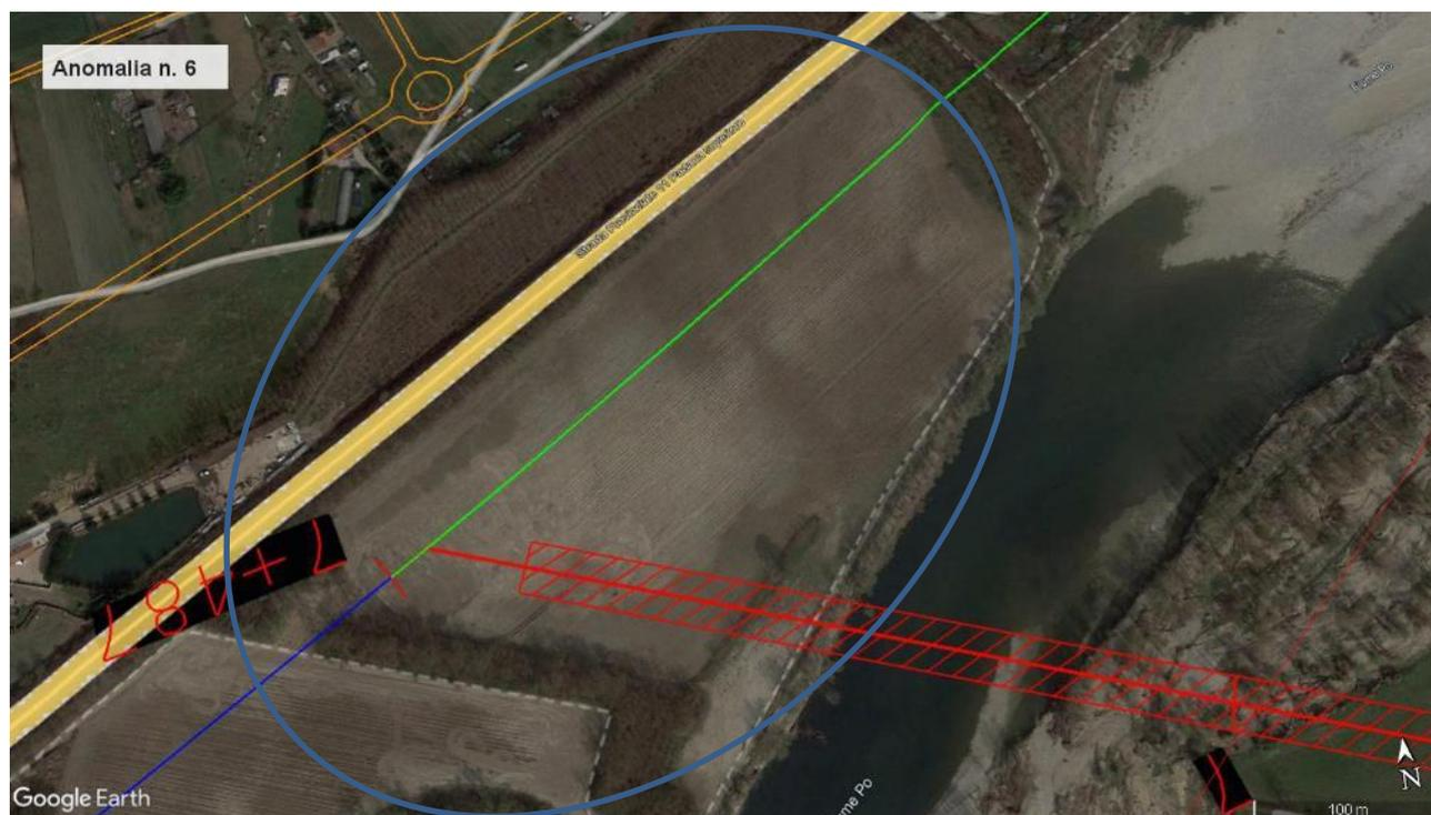
**Figura 6.1-9 Anomalia n. 6 da foto satellitare (Fonte Google Earth, 3/2017) dell'area di progetto. In rosso il tracciato del metanodotto in progetto, in verde la condotta in dismissione. Il cerchio blu evidenzia le tracce anomale lineari, di probabile origine naturale, legate alla divagazione fluviale.**
