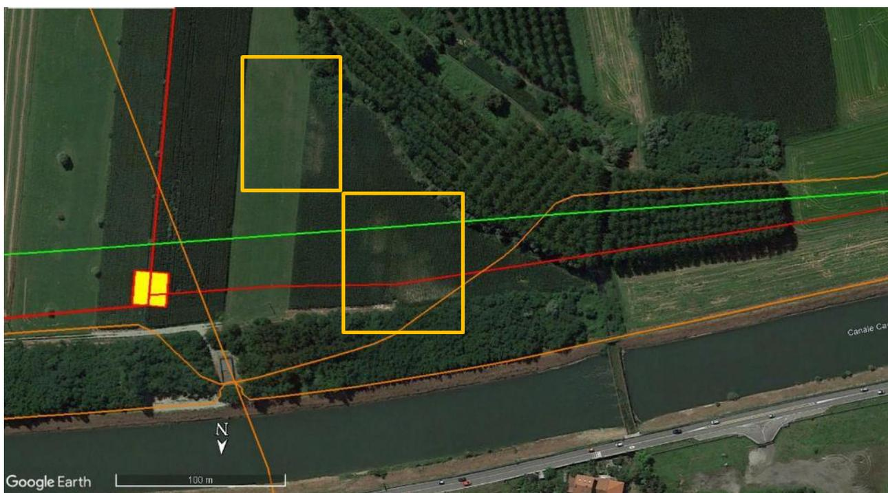
**Figura 6.1-1** Anomalia n. 1 da foto satellitare (Fonte Google Earth, 8/2016) dell'area di progetto. In rosso il tracciato del metanodotto in progetto, in verde la linea in dismissione. I rettangoli arancioni evidenziano le anomalie.
