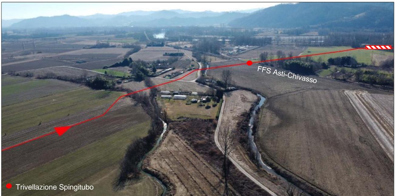
Foto 1.3.1-2 Avanzamento della nuova condotta ed attraversamento della FFS Asti-Chivasso (in manutenzione)
