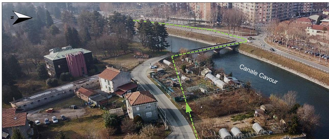
**Foto 1.5.1-1 Attraversamento C.le Cavour azzancato a ponte Via Mezzano; a valle di quest'ultimo, la condotta si trova in percorrenza stradale per circa 270 metri**
