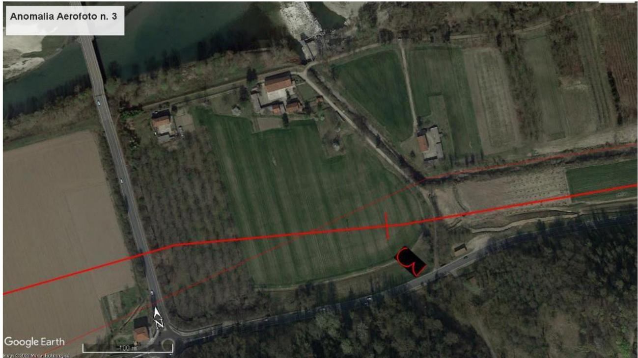
**Figura 6.1-5 Anomalia n. 3 da foto satellitare (Fonte Google Earth, 3/2021) dell'area di progetto. In rosso il tracciato del metanodotto in progetto. La linea blu evidenzia le tracce anomale lineari, di probabile origine naturale, legate alla divagazione del fiume.**
