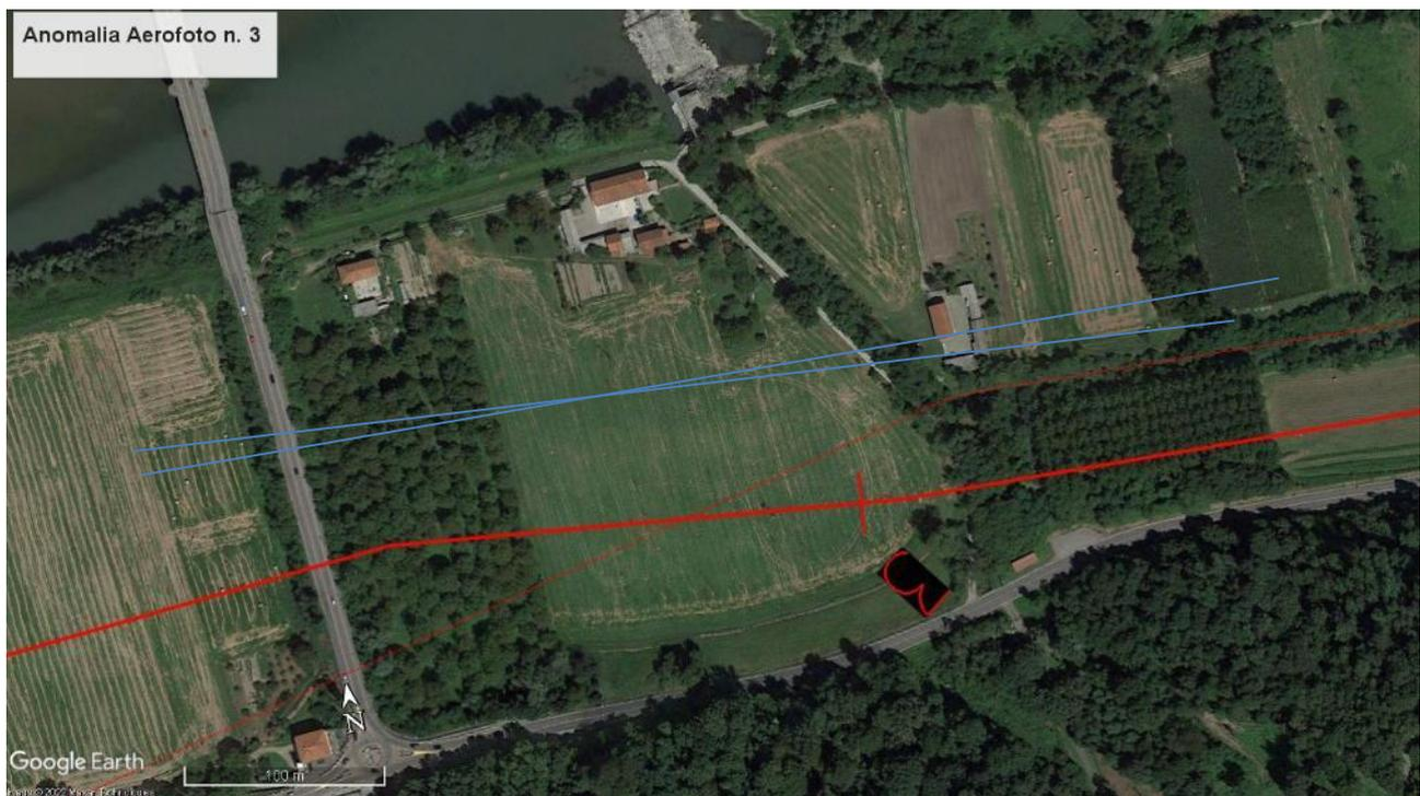
**Figura 6.1-4 Anomalia n. 3 da foto satellitare (Fonte Google Earth, 8/2016) dell'area di progetto. In rosso il tracciato del metanodotto in progetto. La linea blu evidenzia le tracce anomale lineari, di probabile origine naturale, legate alla divagazione del fiume.**
