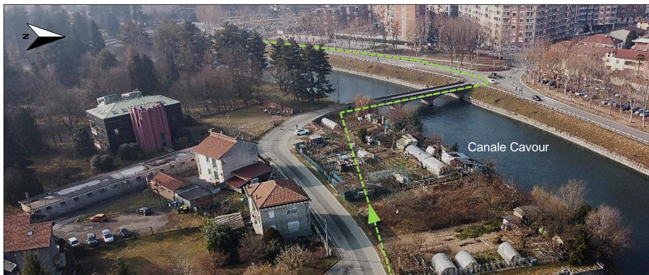
**Foto 5.2.1/A - Attraversamento C.le Cavour azzancato a ponte Via Mezzano; a valle di quest'ultimo, la condotta si trova in percorrenza stradale per circa 270 metri**
