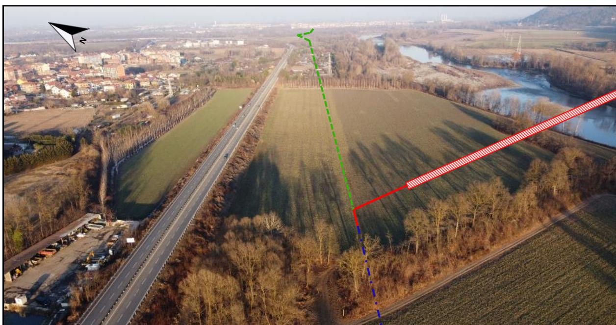
Foto 5.1.1/S - Tratto terminale della nuova condotta, a valle del 3° Microtunnel (PK 7+485)
