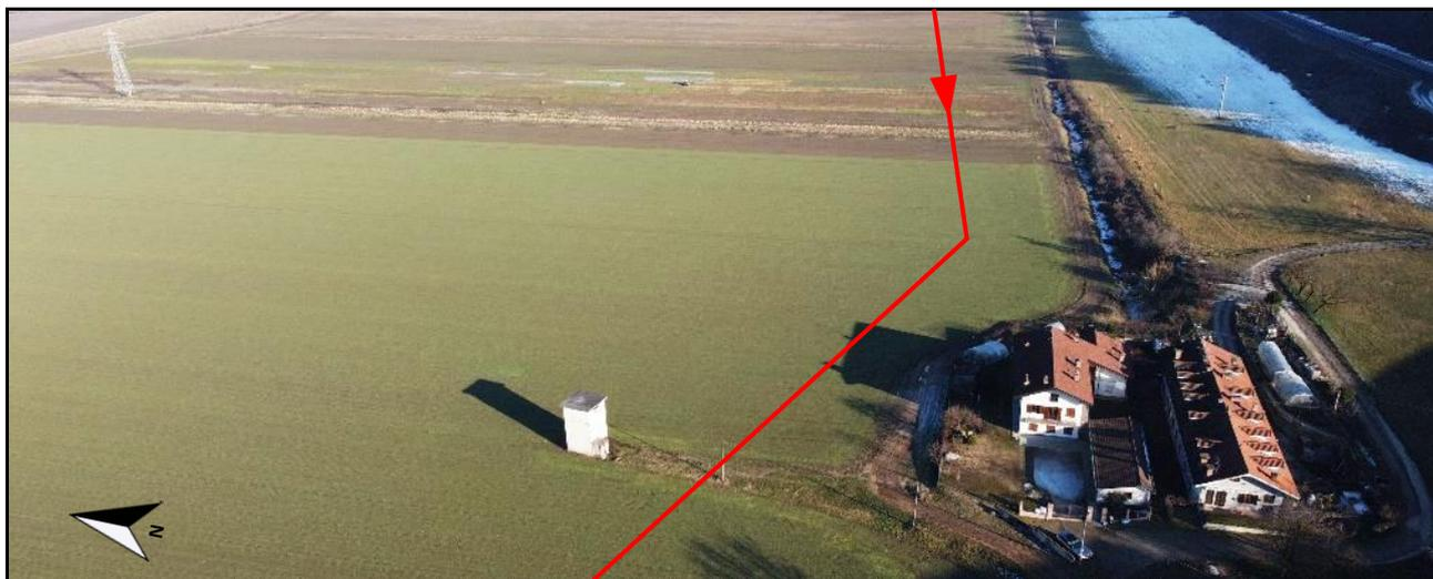
Foto 5.1.1/P - Leggera deviazione in destra senso gas prima del nuovo impianto PIL n.3 (PK 6+146)
