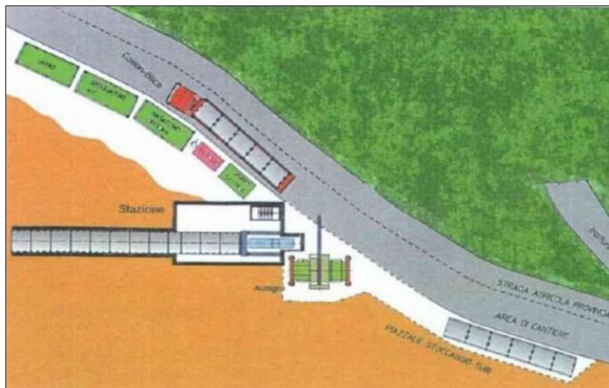
Fig. 8.1.11/B - Schema tipo di un cantiere per l'installazione di un microtunnel
