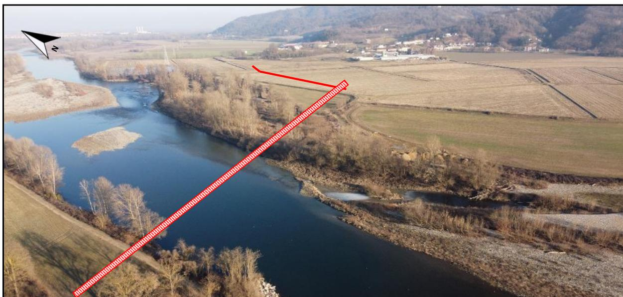
Foto 5.1.1/R - Microtunnel n.3 – Attraversamento Fiume Po (PK 7+138)
