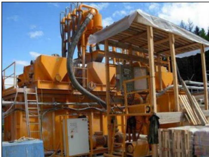
Figura 7.1.11/D – Sistema di disidratazione
