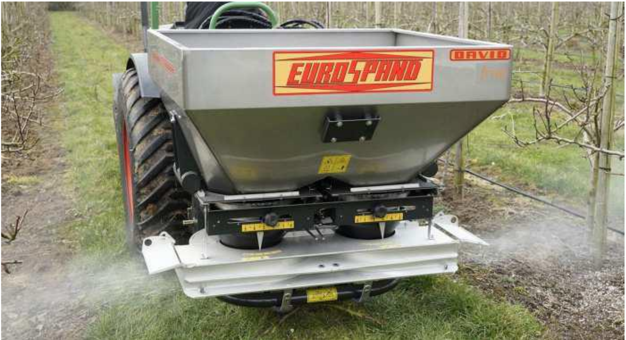
esempio di spandiconcime localizzato mono/bilaterale per frutteti
