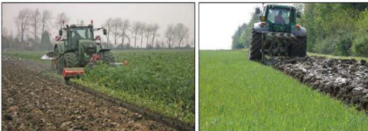
Esempio di pratica del sovescio in pieno campo. Si noti, nell’immagine a sinistra, l’impiego di una trincia frontale montata sulla stessa trattrice per alleggerire il carico sull’aratro portato
