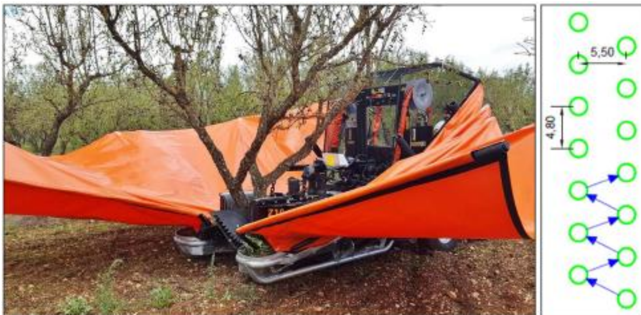
Macchina frontale per la raccolta delle mandorle su impianto intensivo e disposizione ideale degli alberi per il corretto impiego della stessa
