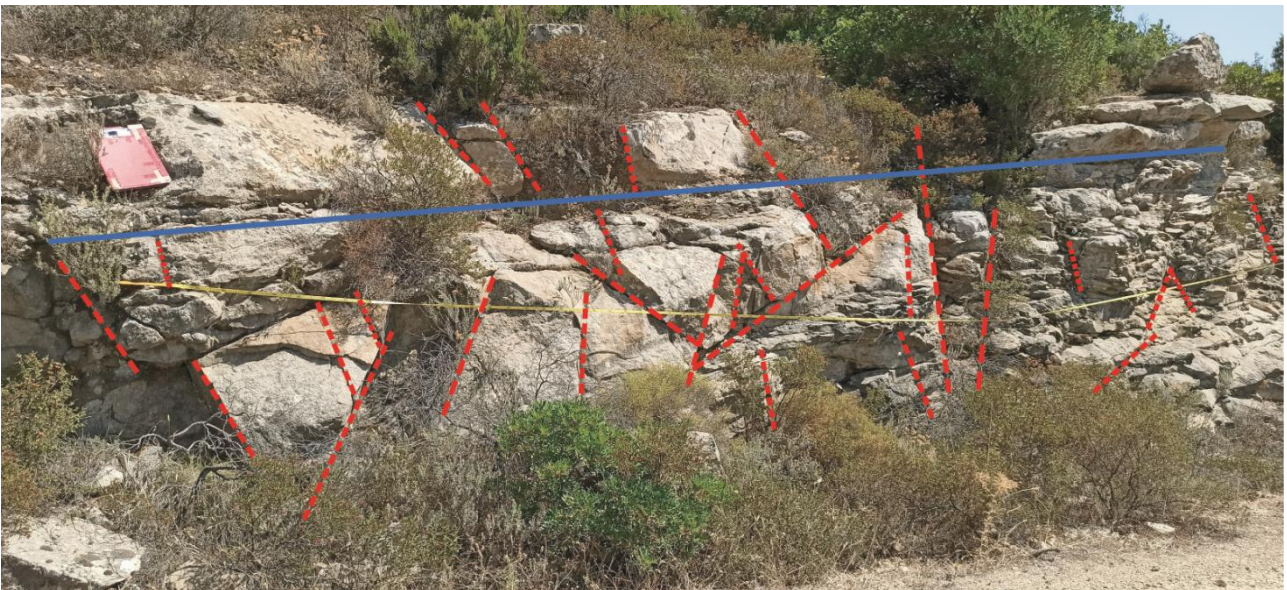
Figura 7. 12: Vista sull'affioramento della formazione di Monte Cardiga (FMC-7) con evidenziate la stratificazione (in blu) e le tracce dei giunti di fratturazione (in rosso).
