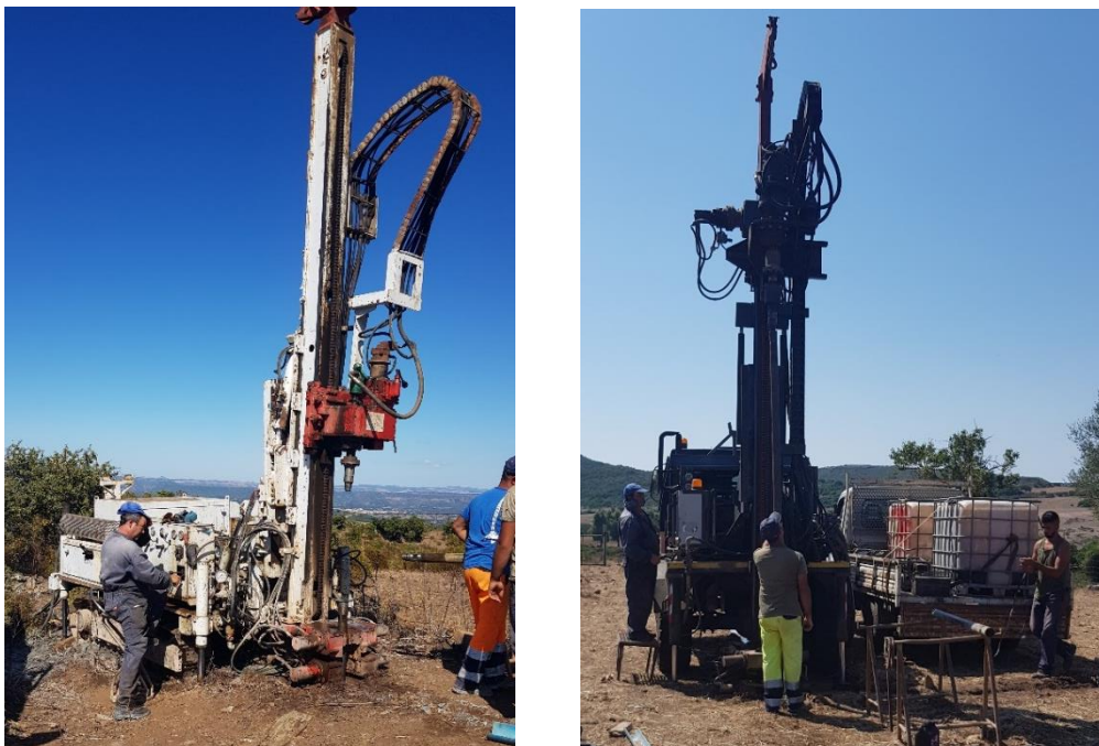
Figura 14. 2: a) Sonda BOART LONGYEAR SPA Mod. DELTBASE 520 e b) Sonda idraulica Hydra mod. Joy3
