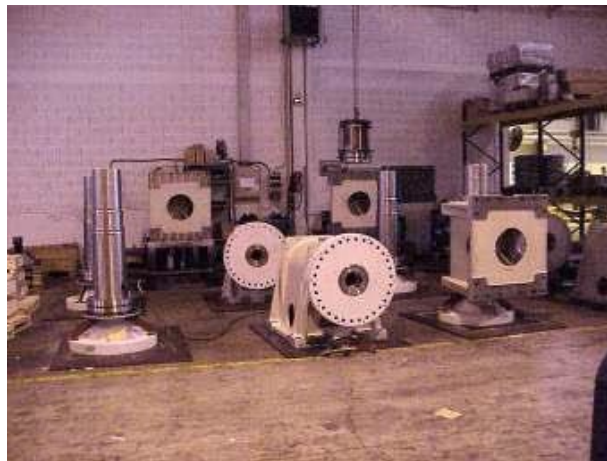
Foto 2. Asse di bassa velocità
