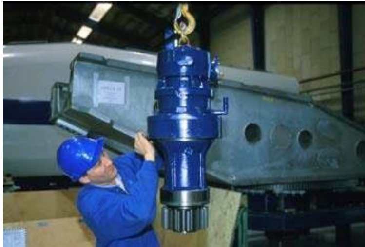
Foto 6. Motori di giro e riduttori
