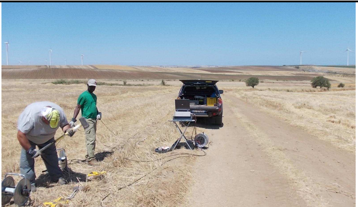
[particolare dell'esecuzione di una battuta in onde P nella Base Sismica B.S.1]
