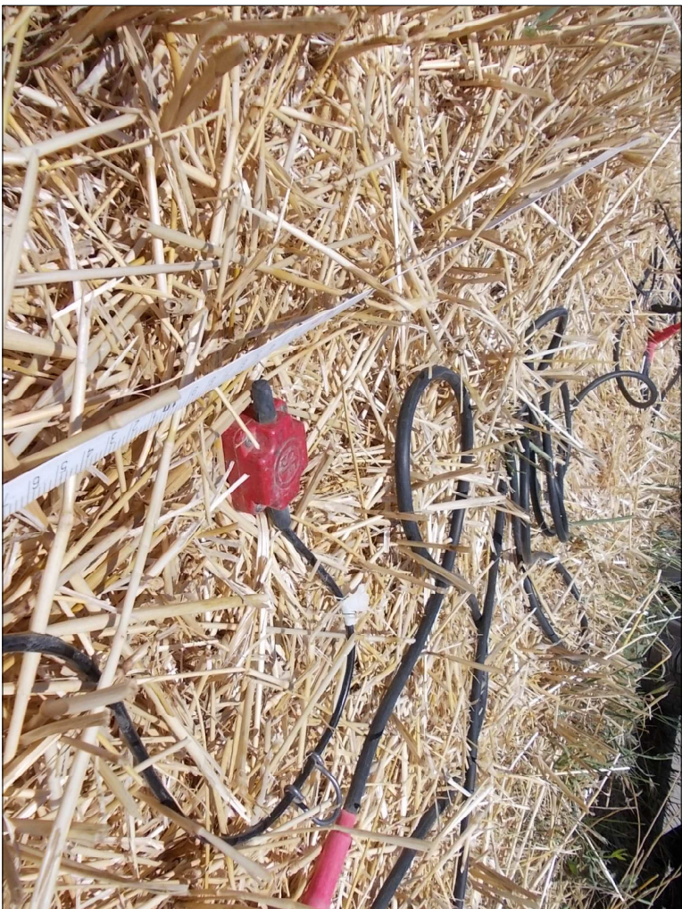
Foto 12: Particolare di un geofono utilizzato nella Prova MASW.1
