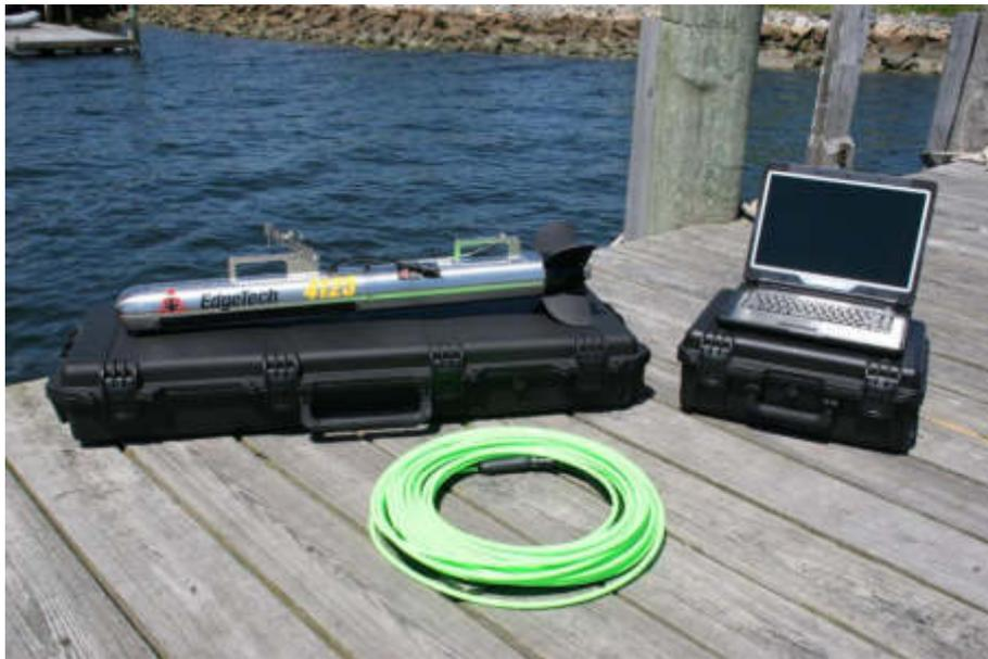
**Figura 10: Elementi che compongono la strumentazione Side Scan Sonar**
