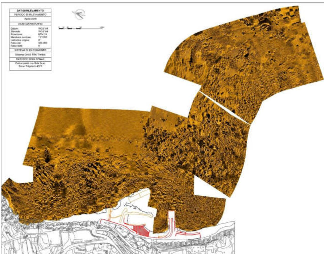
Figura 11: Elaborazione dati Side Scan Sonar
