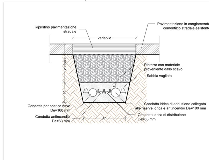
Sezione di posa rampa - scala 1:25
