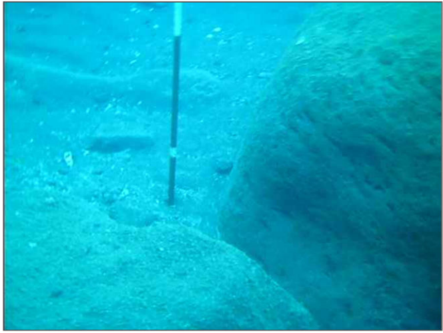
P2 (profondità di infissione 0.25 m)
