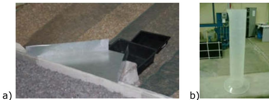
**Figura 4.8** a) Contenitore di raccolta della portata tracimata (32x48 cm) e scivolo in acciaio per l'incanalamento dell'acqua all'interno della stessa vaschetta; b) boccale graduato (1000 ml) usato per la misura del volume d'acqua tracimato in un intervallo di tempo predefinito.
