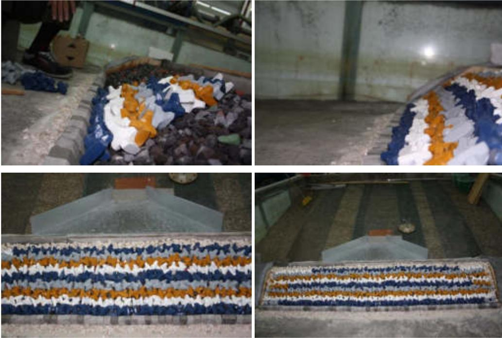
Configurazione 3: Fase costruttiva della mantellata con massi tipo Accropodi e con massi di protezione al piede (lato obliquo del masso rivolto verso la barriera).
