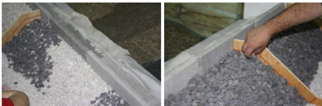
**Figura 4.19** Messa in opera del filtro realizzato mediante materiale basaltico rappresentativo degli scogli di 2-5 t a scala di prototipo.
