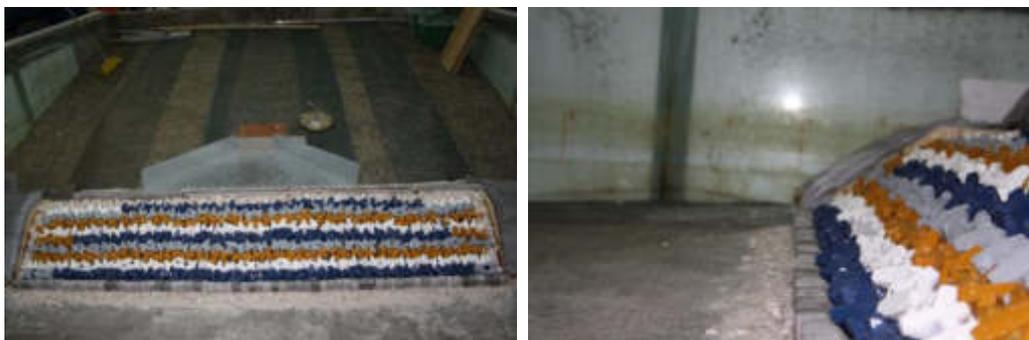
**Figura 4.27** Modello nella Configurazione 3 della diga foranea dello Scalo Galera, in scala 1:80.
