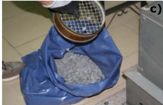
Strumentazione utilizzata per setacciare il materiale adoperato per la realizzazione della barriera: a) setacciature meccanico; b) setacci utilizzati per la selezione granulometrica; c) separazione del materiale setacciato.
