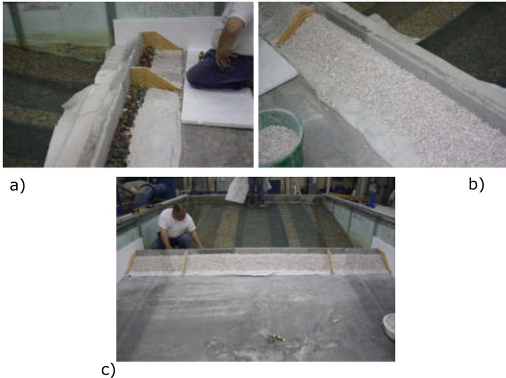
**Figura 4.18** Messa in opera del nucleo sia della parte interna con materiale basaltico (a) sia della parte esterna con granulato di marmo (b) rappresentativi rispettivamente della III categoria e degli scogli e massi provenienti da salpamenti e rocce di I categoria.
