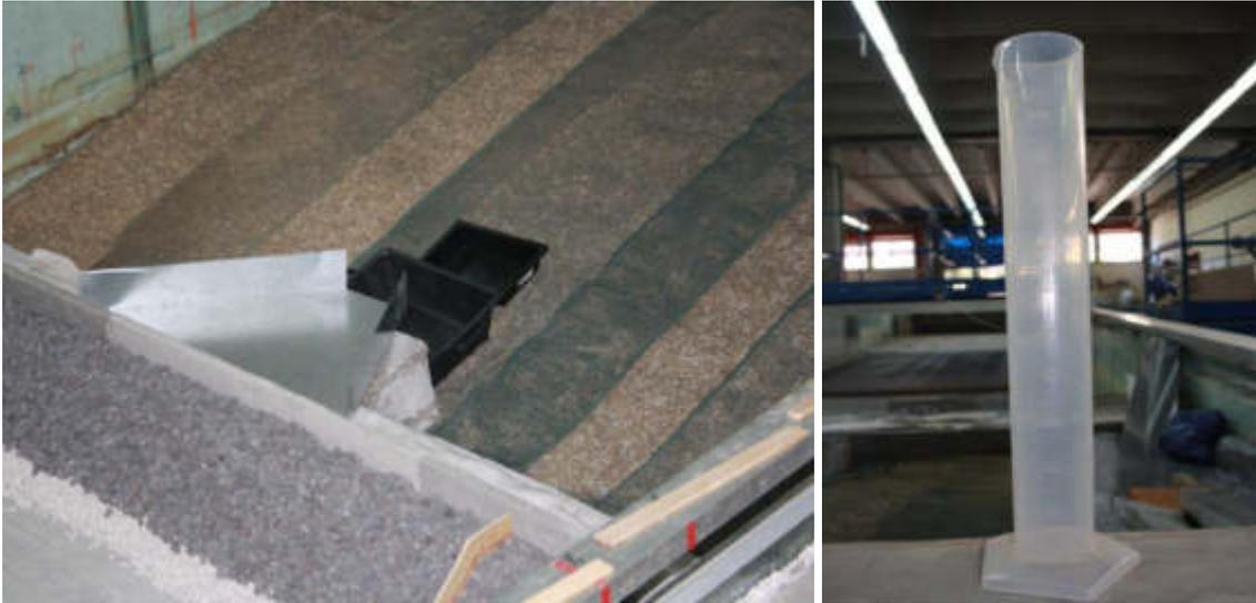
Strumentazione utilizzata per la valutazione della portata tracimata: scivolo per la raccolta della portata di overtopping (a sinistra) e boccale graduato per la misurazione (a destra).
