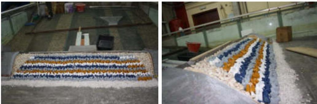
**Figura 4.23** Modello nella Configurazione 1 della diga foranea dello Scalo Galera, in scala 1:80.
