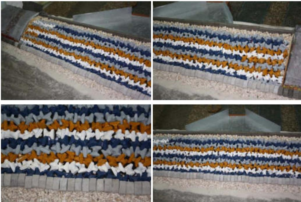
Configurazione 2: Fase costruttiva della mantellata con massi tipo Accropodi e con massi di protezione al piede (lato obliquo del masso rivolto verso il largo).
