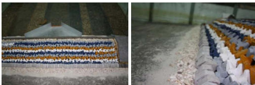
**Figura 4.25** Modello nella Configurazione 2 della diga foranea dello Scalo Galera, in scala 1:80.
