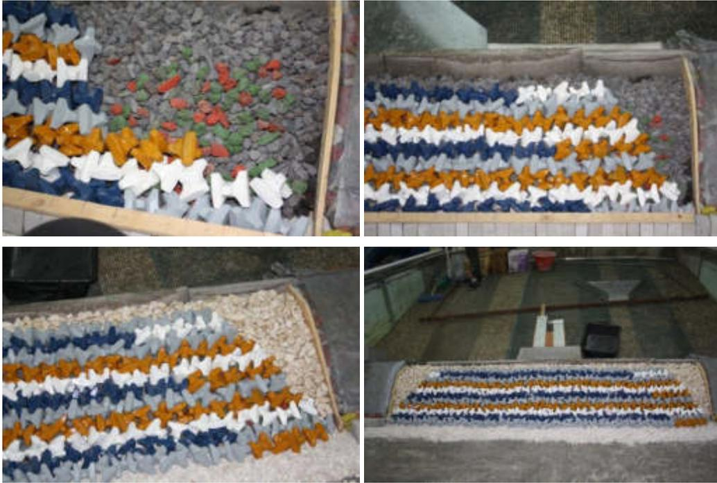
Configurazione 1: Fase di costruzione della mantellata con massi tipo Accropodi e con massi di protezione al piede tipo Accropodi.
