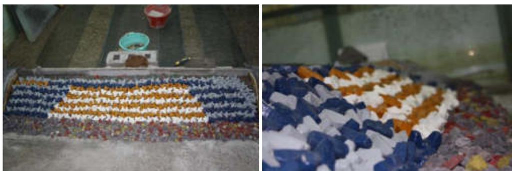
**Figura 4.29** Modello nella Configurazione 4 della diga foranea dello Scalo Galera, in scala 1:80.
