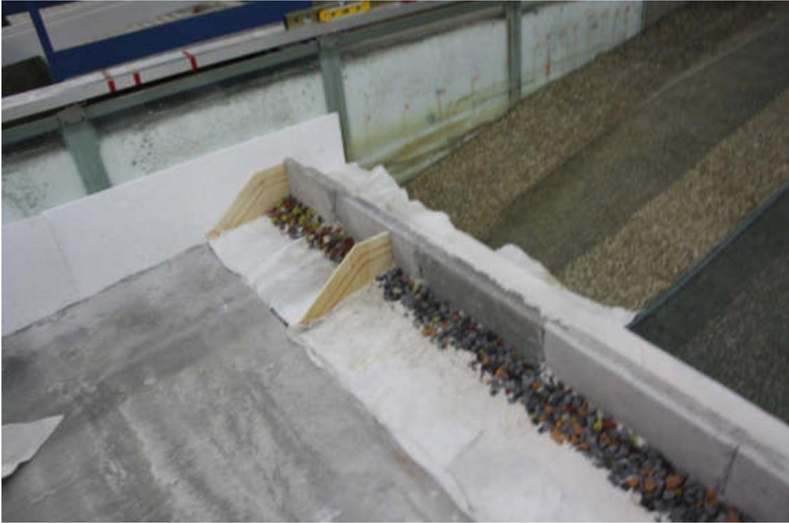
Riempimento della parte interna del nucleo con basalto di III categoria.
