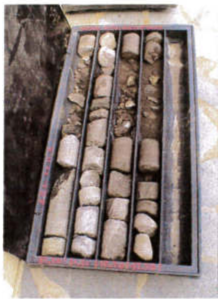
SONDAGGIO ST1 - Da m 13.50 a m 20.00
