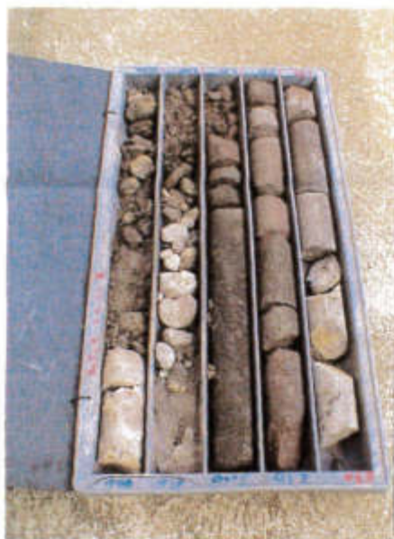
SONDAGGIO ST1 - Da m 0.00 a m 6.50
