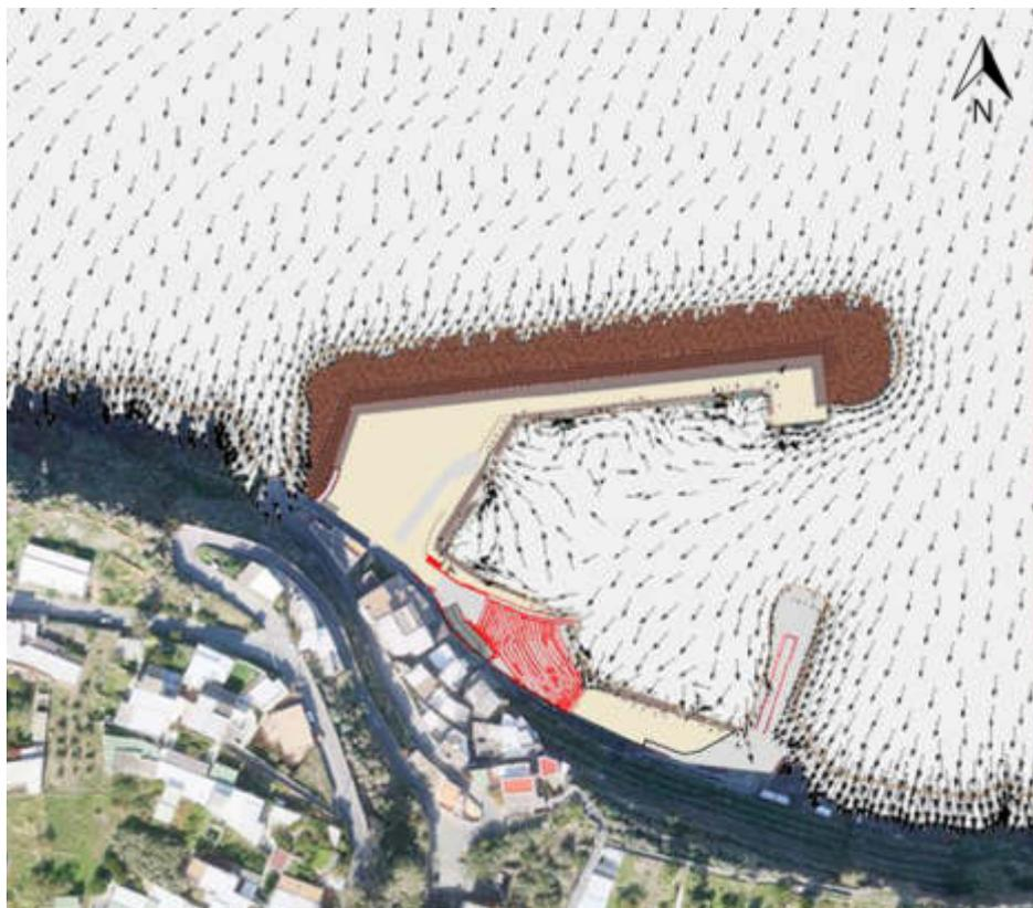
Figura 2 - Stato delle agitazioni interne:  $T_r = 3$  anni; Dir.sottocosta  $21.00^\circ N$
