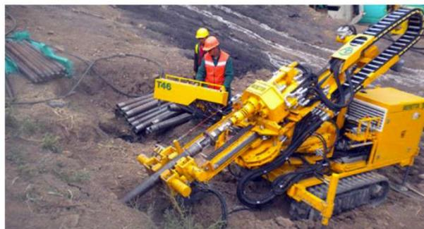
Figura 4. Sonda perforatrice Beretta T-46.
