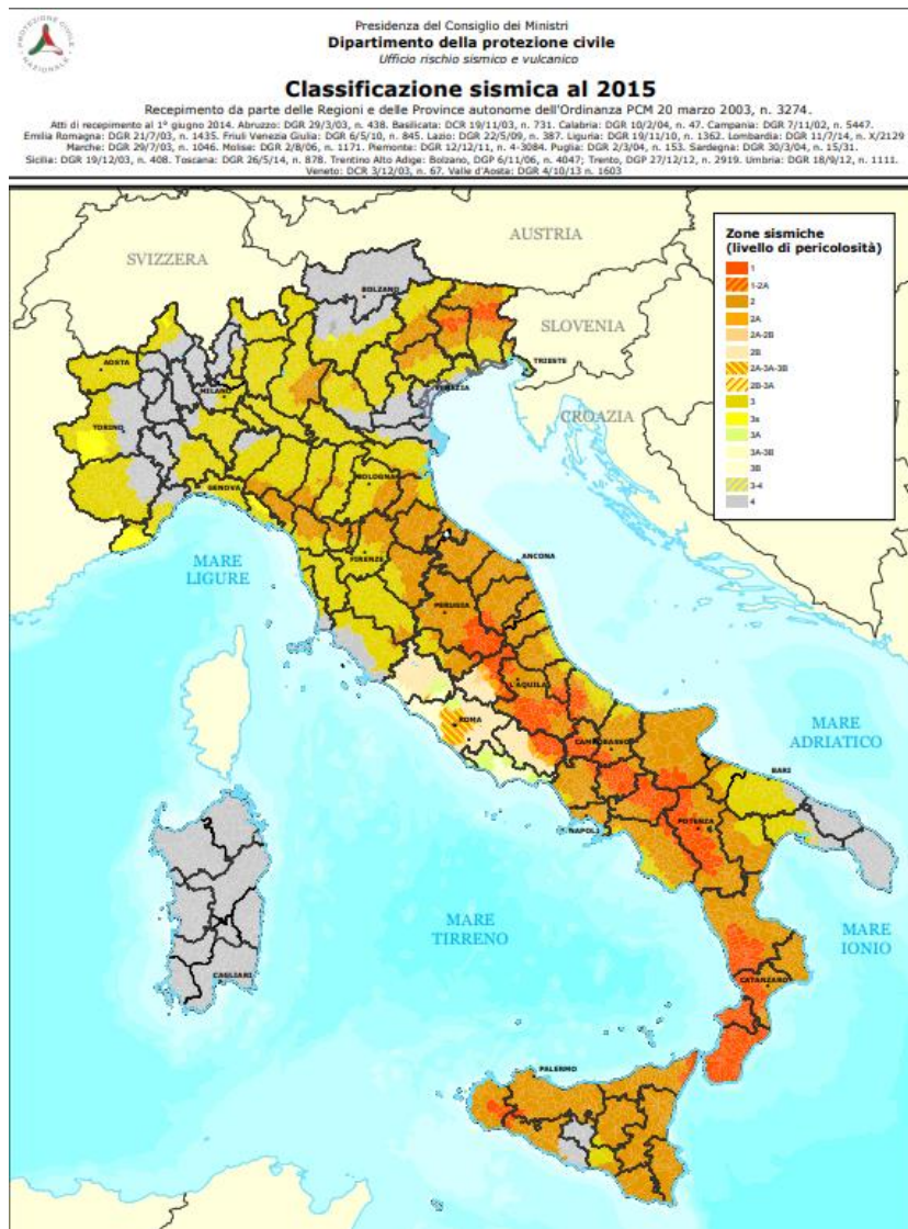
Zonazione sismica dell'Italia.
