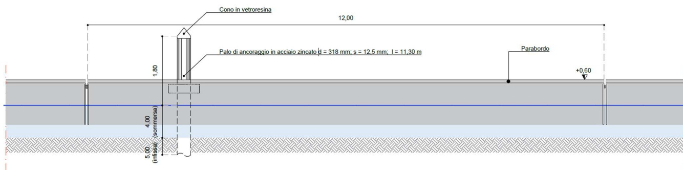
Figura 9-14 Sezione longitudinale pontile galleggiante
