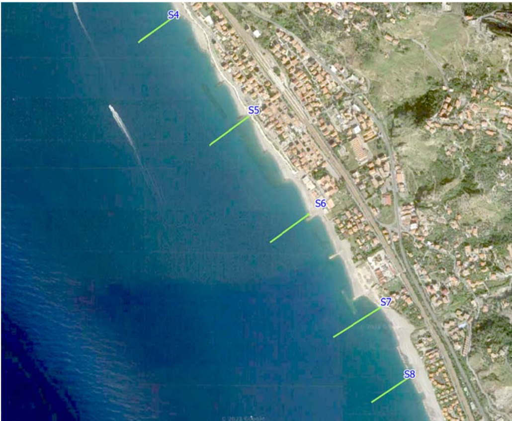
Figura 2. Transetti perpendicolari alla linea di costa passanti per i punti S4, S5, S6, S7, S8 di lunghezza 200 m. In nessuno dei transetti è stata raggiunta l'isobata - 12 entro i 200 m..
