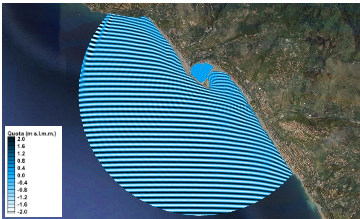
Figura 9.10 TEST 4: mareggiata di Mezzogiorno (180°N), andamento delle creste
