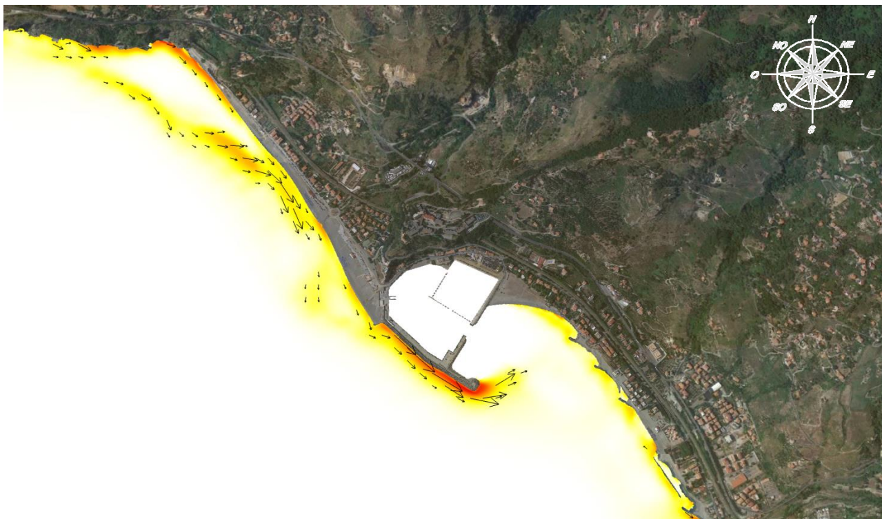
Figura 12.11 TEST 11 – Mareggiata di Ponente - Trasporto solido
