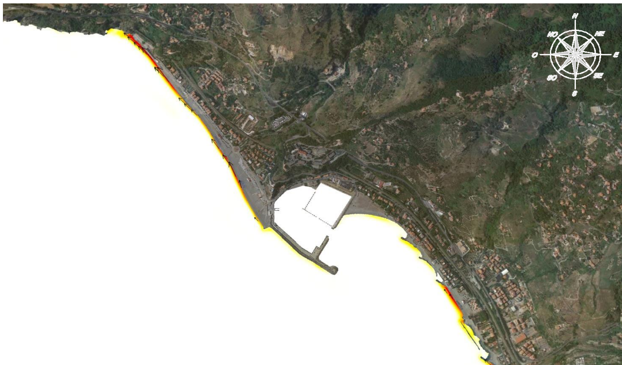
Figura 12.13 TEST 2 – Mareggiata di Scirocco-Mezzogiorno - Trasporto solido
