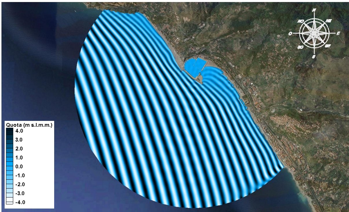
Figura 9.11 TEST 6 mareggiata di Ponente (260°N), andamento delle creste
