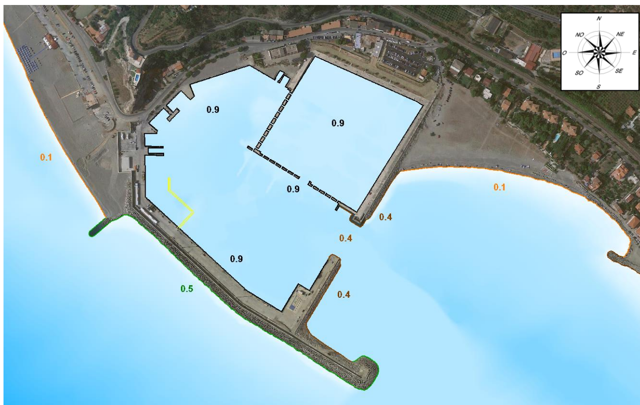
Figura 11.15 Coefficienti di riflessione impiegati nello studio dell'agitazione ondosa nella Configurazione di Progetto 2022
