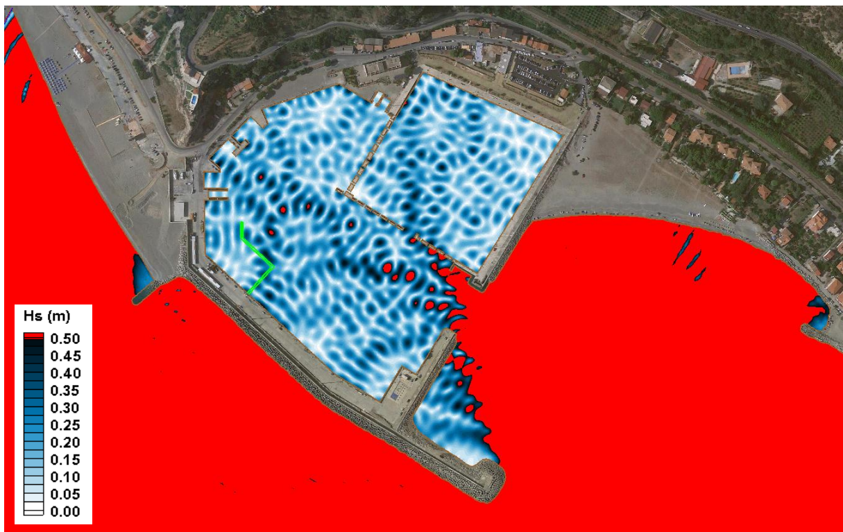
Figura 11.17 TEST 8, verifica delle condizioni "limite"
