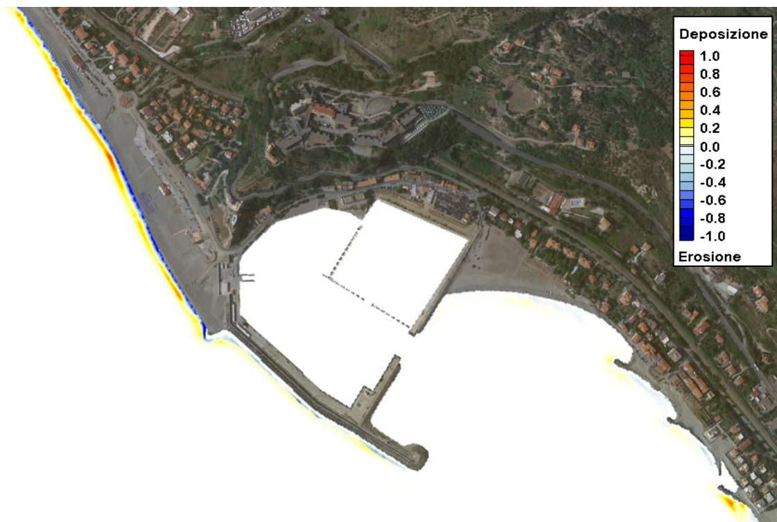
Figura 12.16 TEST 12 – Mareggiata di Scirocco-Mezzogiorno - Evoluzione dei fondali
