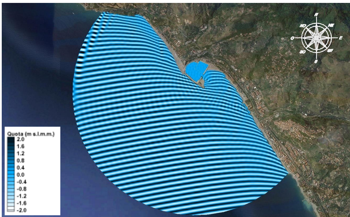
Figura 9.9 TEST 3: mareggiata di Scirocco-Mezzogiorno (160°N), andamento delle creste
