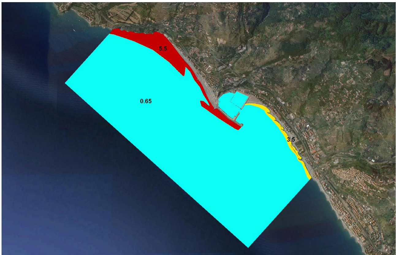
Figura 12.10 Schematizzazione della tessitura dei fondali nel dominio di calcolo
