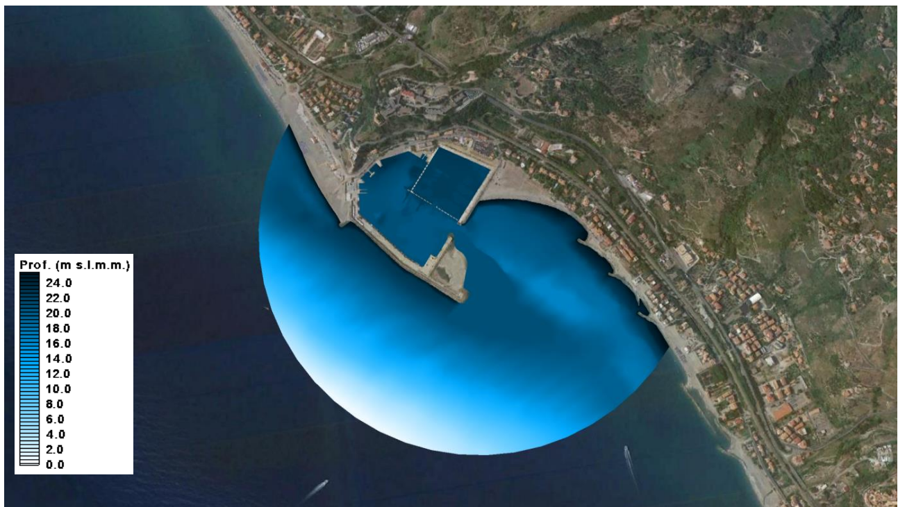
Figura 9.2 Dominio di calcolo impiegato nello studio delle mareggiate generate da vento sotto costa
