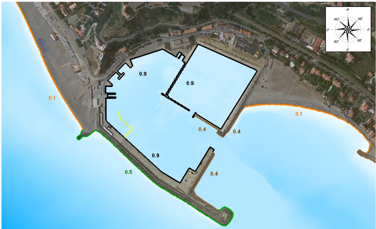
Figura 11.2 Coefficienti di riflessione impiegati nello studio dell'agitazione ondosa nella Configurazione di Progetto 2019
