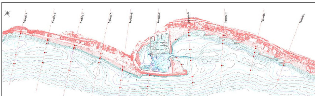
Figura 12.9 Posizione dei transetti e dei campioni di sedimenti prelevati nella spiaggia emersa e sommersa
