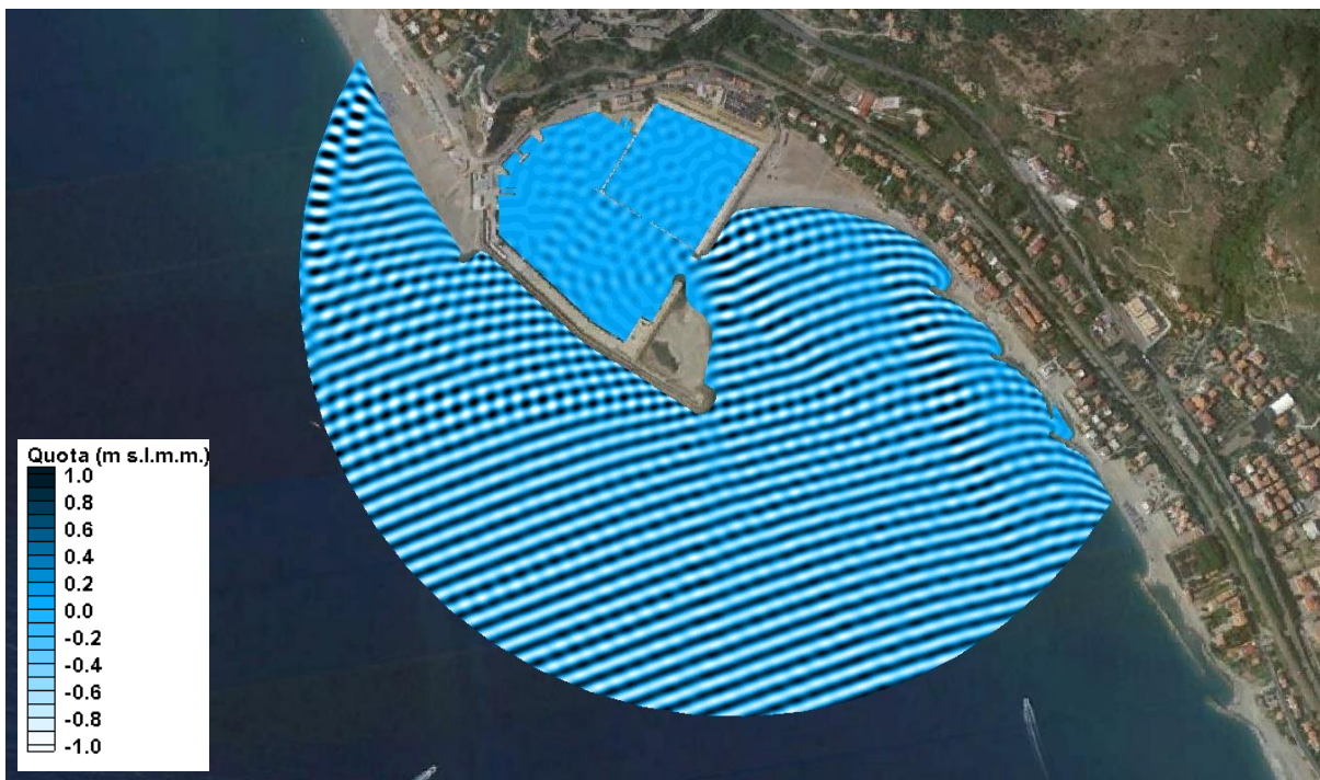
Figura 9.12 TEST 8 mareggiata generata da vento (150°N), andamento delle creste
