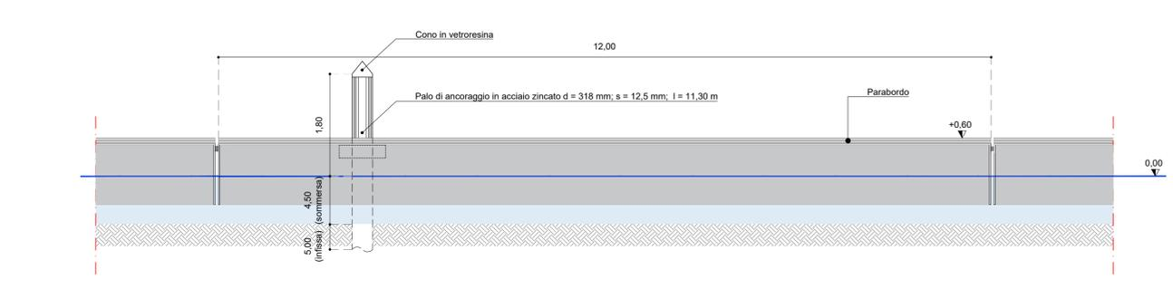
SEZIONE ELEMENTI GALLEGGIANTI A GALLEGGIAMENTO CONTINUO- scala 1:25
