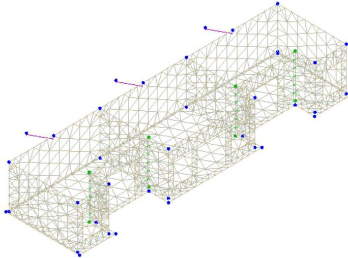
Dalle illustrazioni precedenti si evince come le aste, sia travi che pilastri, siano schematizzate con un tratto flessibile centrale e da due tratti (braccetti) rigidi alle estremità. I nodi vengono posizionati sull'asse verticale dei pilastri, in corrispondenza dell'estradosso della trave più alta che in esso si collega. Tramite i braccetti i tratti flessibili sono quindi collegati ad esso.
