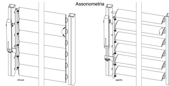
SISTEMA DI FISSAGGIO DELLE PALE
