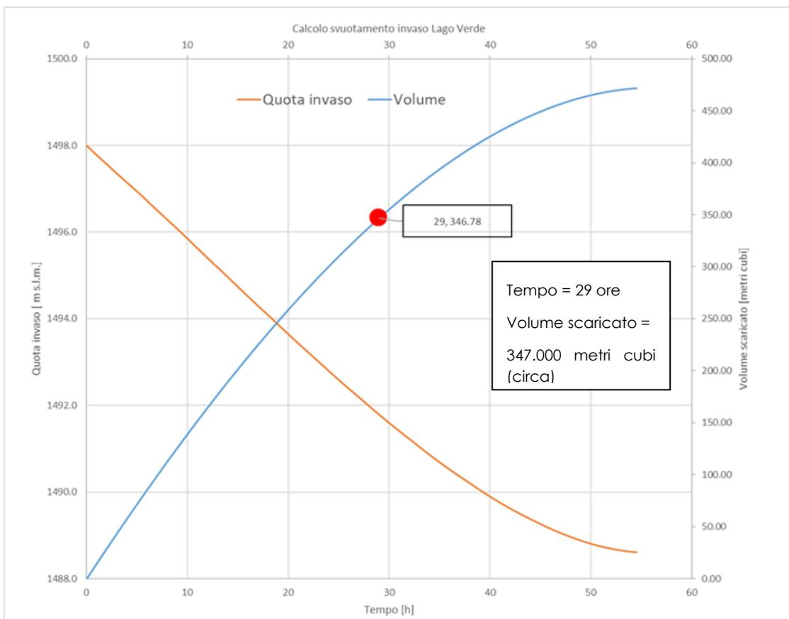
Figura 22 - Processo di svuotamento dell'invaso - variazione volume e quote in funzione del tempo
