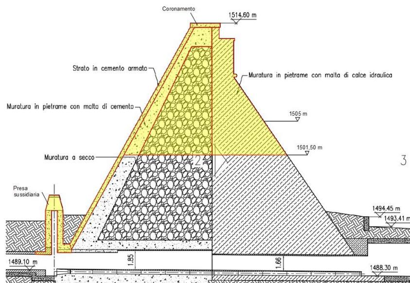
Figura 34 - Classificazione del materiale da demolizione
