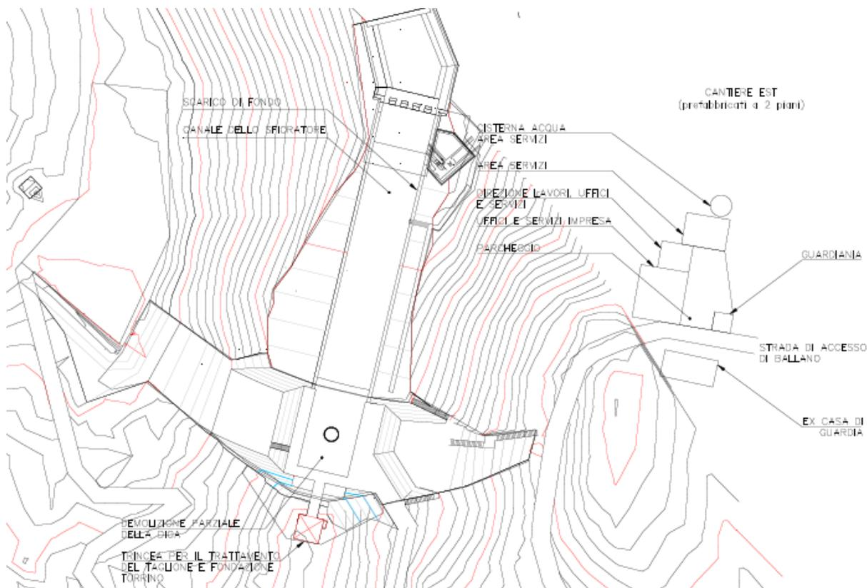
Figura 35 - Particolare aree di lavoro sbarramento ed area di cantiere est
