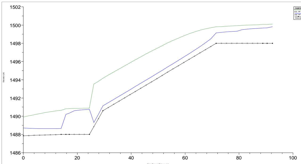
Figura 17 – Profilo idraulico dello sfioratore
