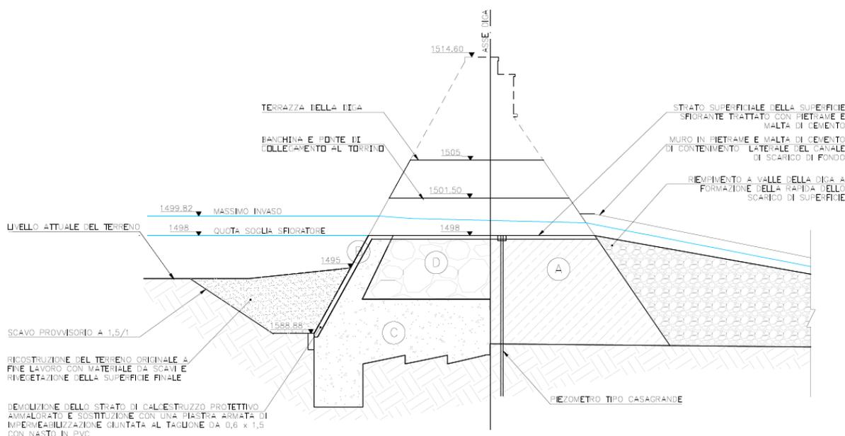
Figura 11 - Sezione trasversale dello sbarramento
