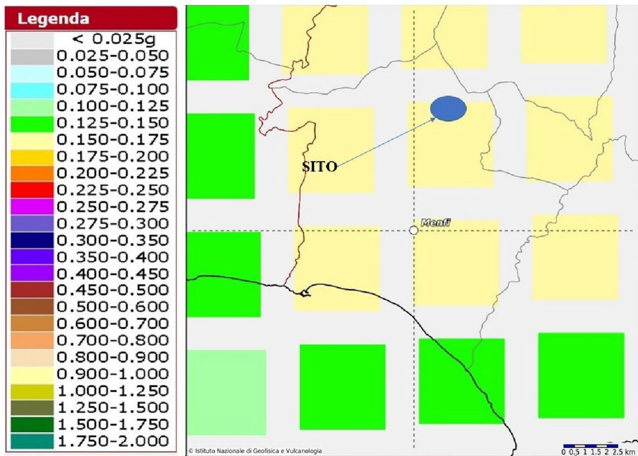
Per il sito in esame, così come si evince dalla mappa interattiva della pericolosità sismica dell'INGV, l'area risulta compresa tra 0.150 - 0.175 g, in pratica l'intervallo di tempo fra fine di un sisma e l'inizio del successivo è compreso tra un range di accelerazione sismica massima tra 0.15 e 0.17. Questo comporta che in fase di realizzazione dell'opera occorrerà seguire le vigenti norme tecniche in zona sismica.
