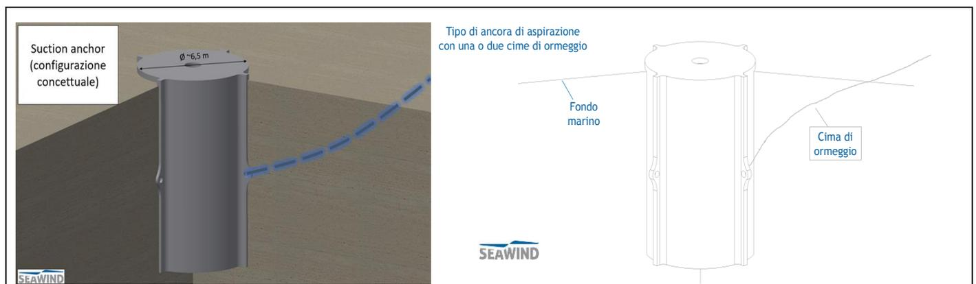
**Figura 30 - Tipologia di ancoraggio ad aspirazione (suction)**
