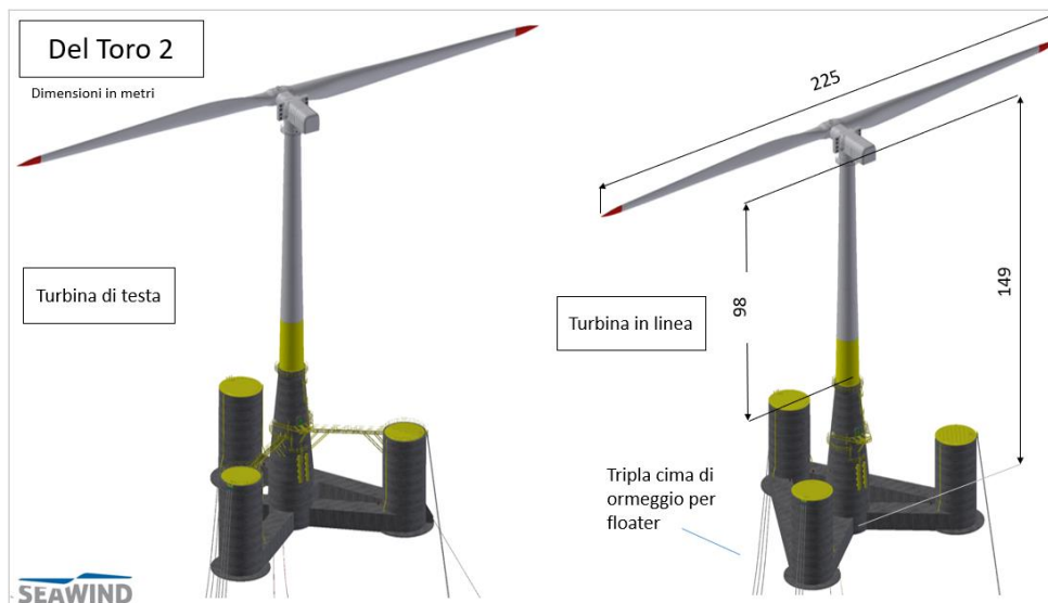
Figura 18 - Unità completa modello Seawind 12 con dettaglio su cime di ormeggio per unità di testa e in linea
