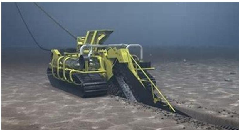
Figura 101 - posa del cavo 220 kV AC
