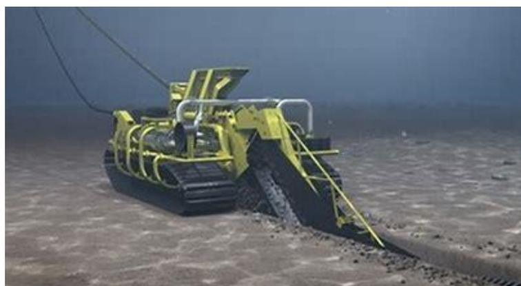
Figura 23 - posa del cavo 220 kV AC
