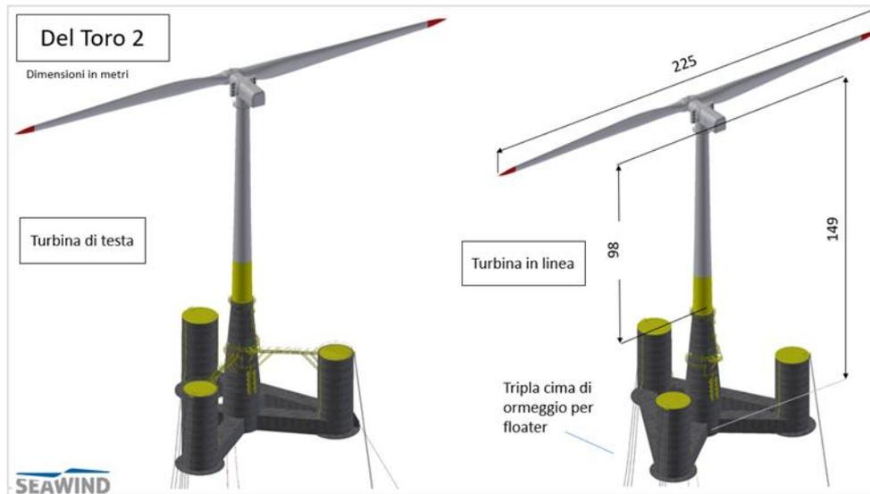
Figura 4: Unità completa modello Seawind 12 con dettaglio su cime di ormeggio per unità di testa e in linea
