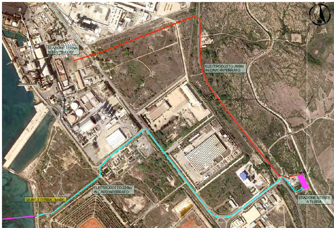
Figura 22 – Tracciato cavidotto interrato 220 kV
