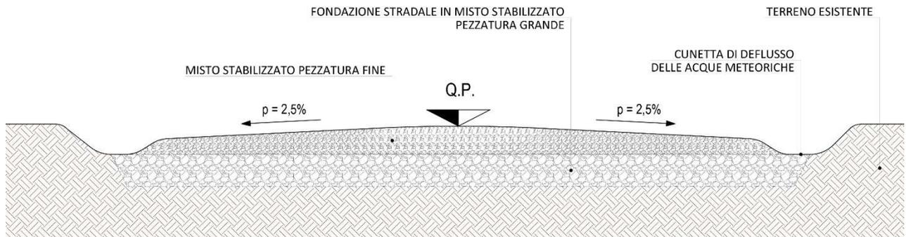
Figura 4 - Sezione tipo viabilità interna
