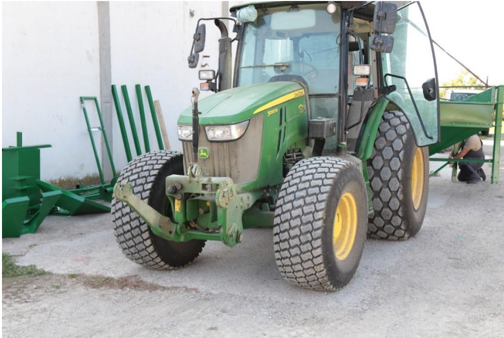
Figura 24. Trattore equipaggiata con gomme anti-compattamento atte a non distruggere le caratteristiche fisiche del suolo.
