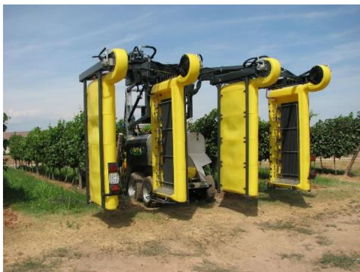
Figura 15. Vista di atomizzatore per pareti continui con barre per il recupero della deriva dei prodotti fitosanitari.
