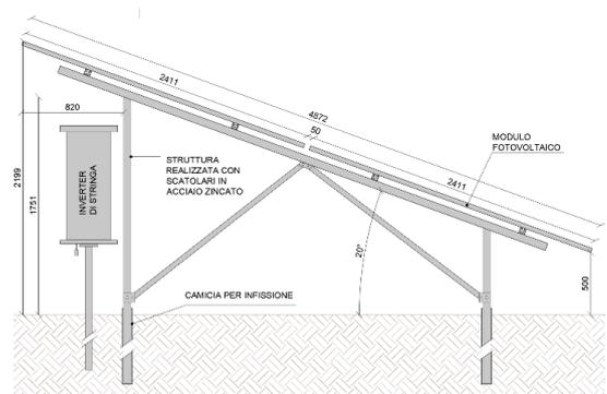
Figura 28- Particolare di una struttura fissa
