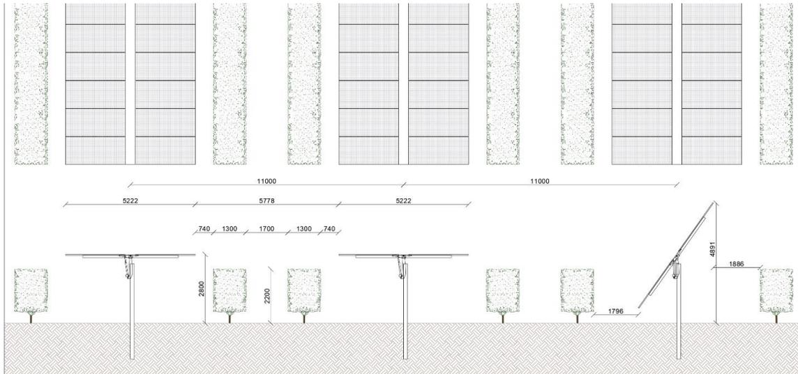
*Figura 13- Sezione tipo dell'assetto agrovoltaico*
