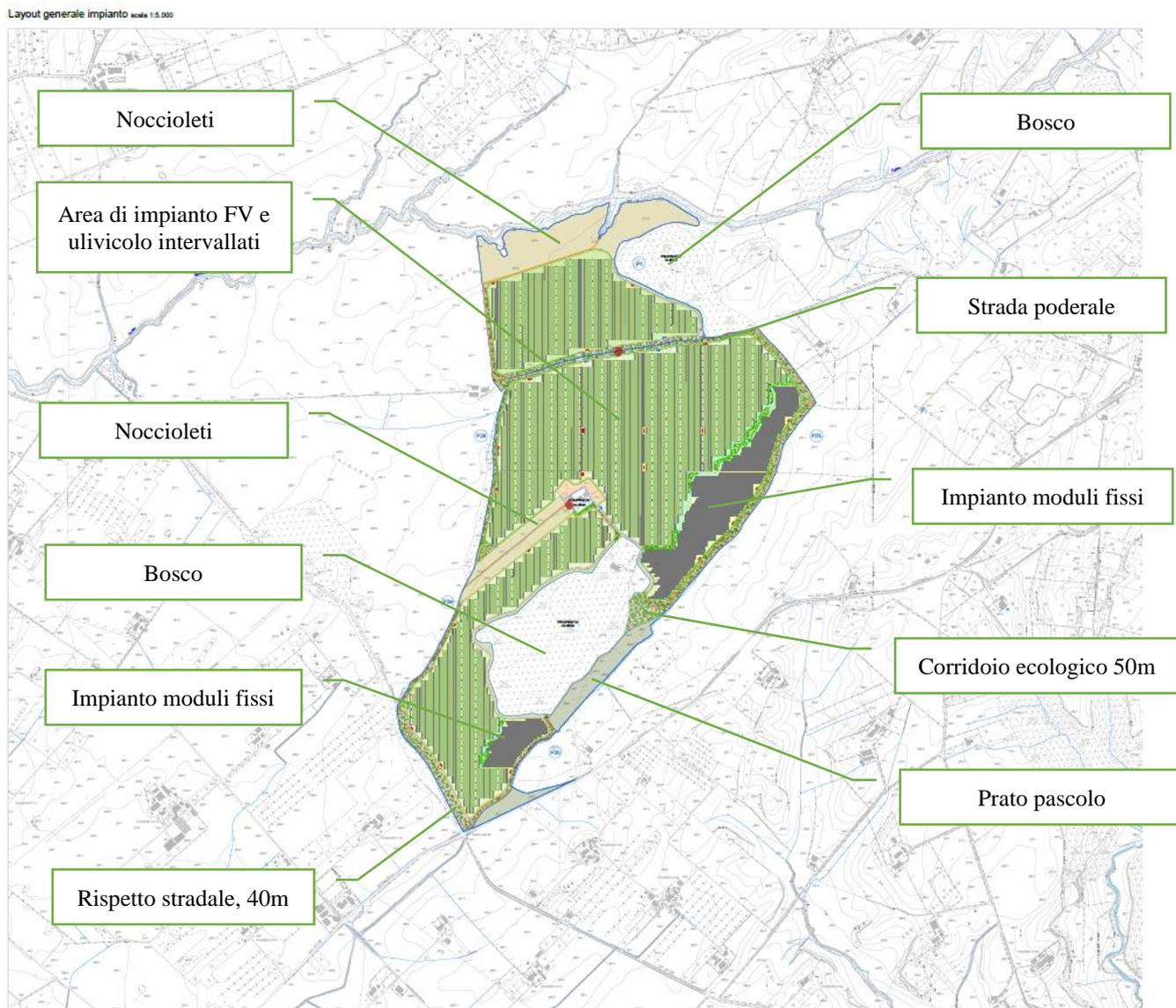
Figura 5 - Lay generale dell'impianto,
