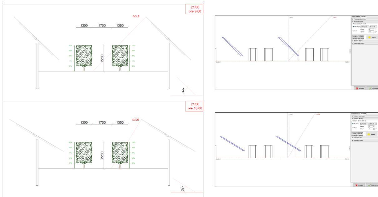
*Figura 76 - Schema ombreggiamento con impianto ulivicolo*
