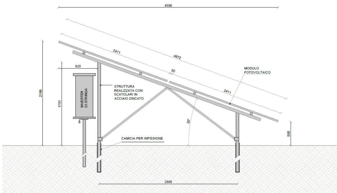
Figura 29 - Struttura fissa
