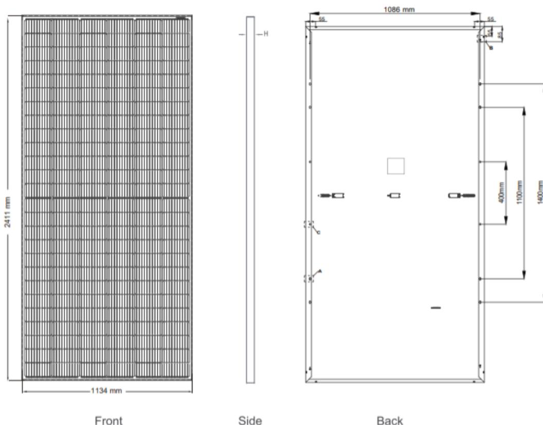
Figura 30- Pannello Jinko Solar modello JKM585M.
