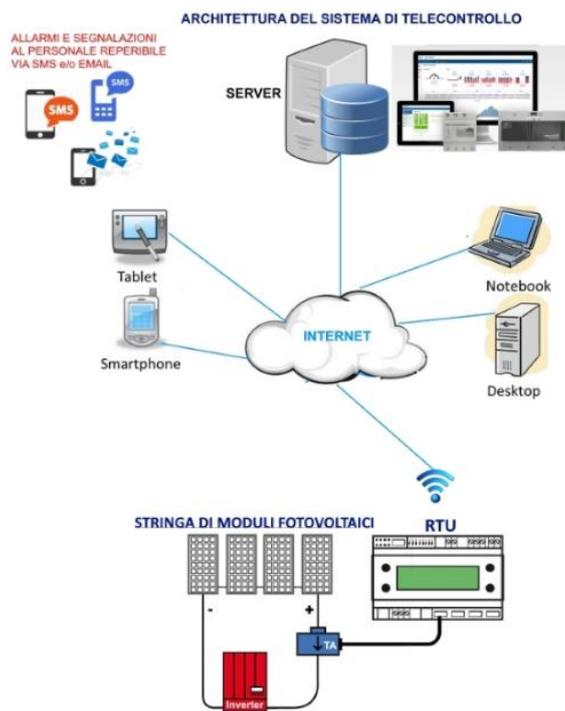
Figura 131 - Schema sistema di telecontrollo
