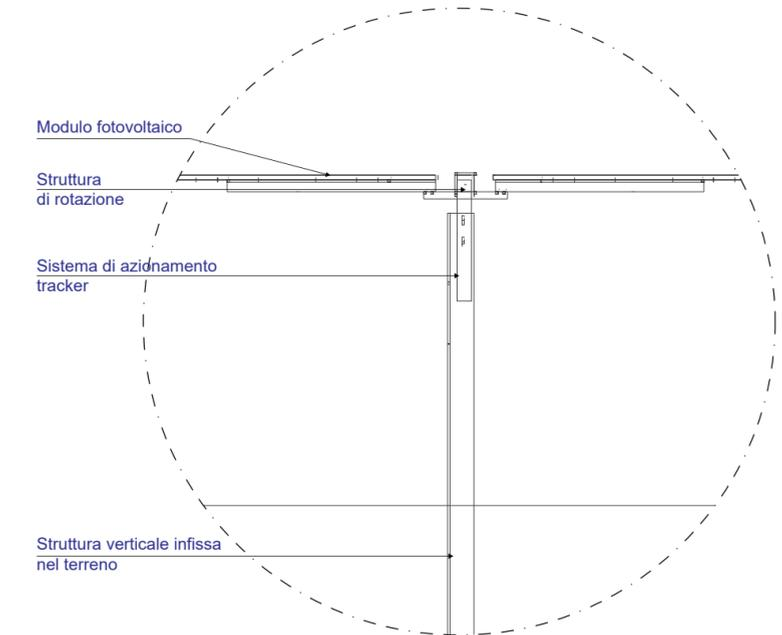
Tracker - Sezione di dettaglio
