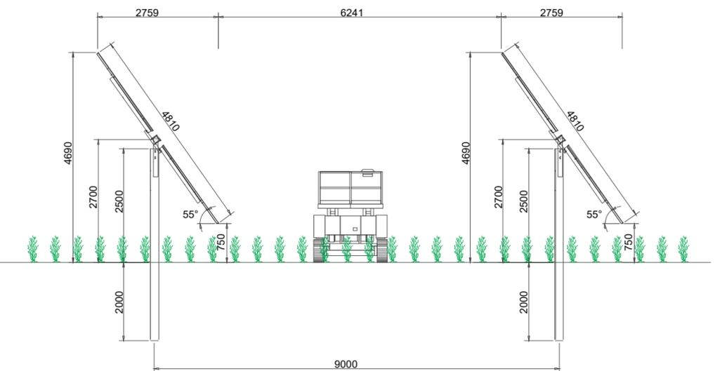
Tracker - Configurazione massima rotazione - Sezione laterale
