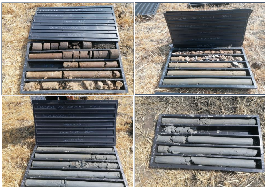
POSTAZIONE SONDAGGIO A CAROTAGGIO S1 E CASSETTE CATALOGATRICI
