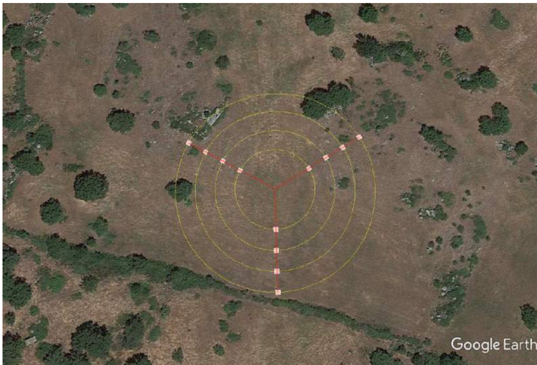
Figura 8 - Scatto fotografico del sito (in alto a sx), Schema grafico della torre anemometrica tipo (in alto a dx) e Orientamento ancoraggi della struttura su Google Earth (in basso)
