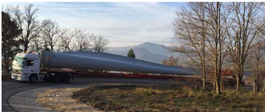
Figure 92 - Soluzione tipo del trasporto della pale e adeguamento in curva tipo sulla viabilità esistente
