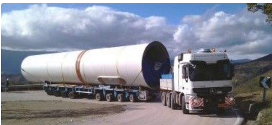
Figure 93 - Soluzione tipo del trasporto dei conchi di torre e adeguamento in curva sulla viabilità esistente
