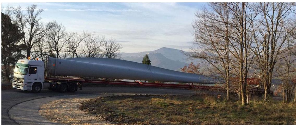
*Figure 36- Soluzione tipo del trasporto della pale e adeguamento in curva tipo sulla viabilità esistente*
