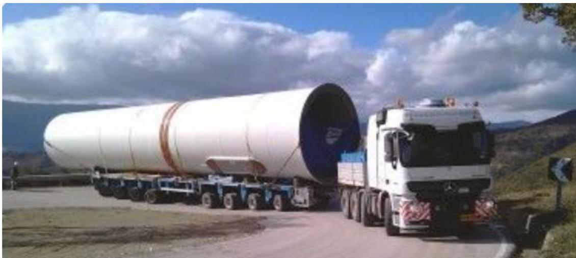
*Figure 37 - Soluzione tipo del trasporto dei conchi di torre e adeguamento in curva sulla viabilità esistente*
