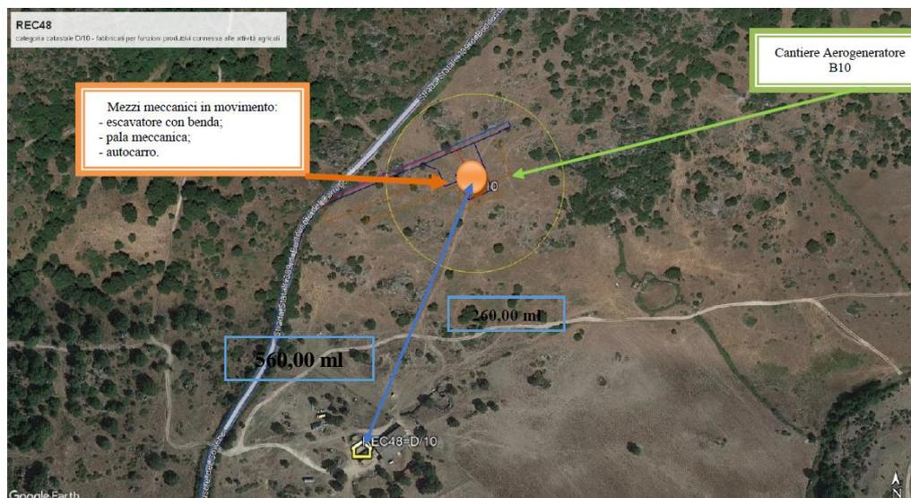
Figura 50 - Scenario 2 fondazioni Aerogeneratore B10
