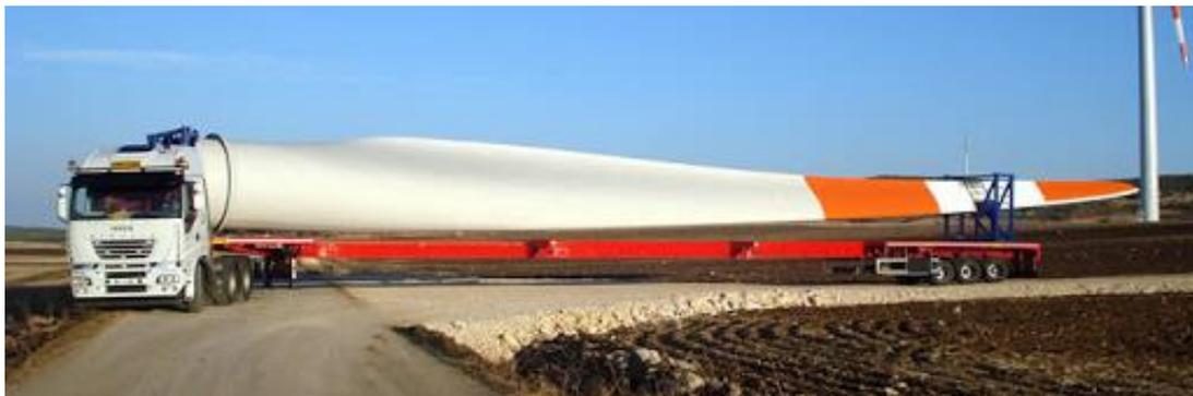
*Figure 38 - Soluzione tipo del trasporto delle pale e pista di nuova realizzazione tipo per l'accesso alla turbina*
