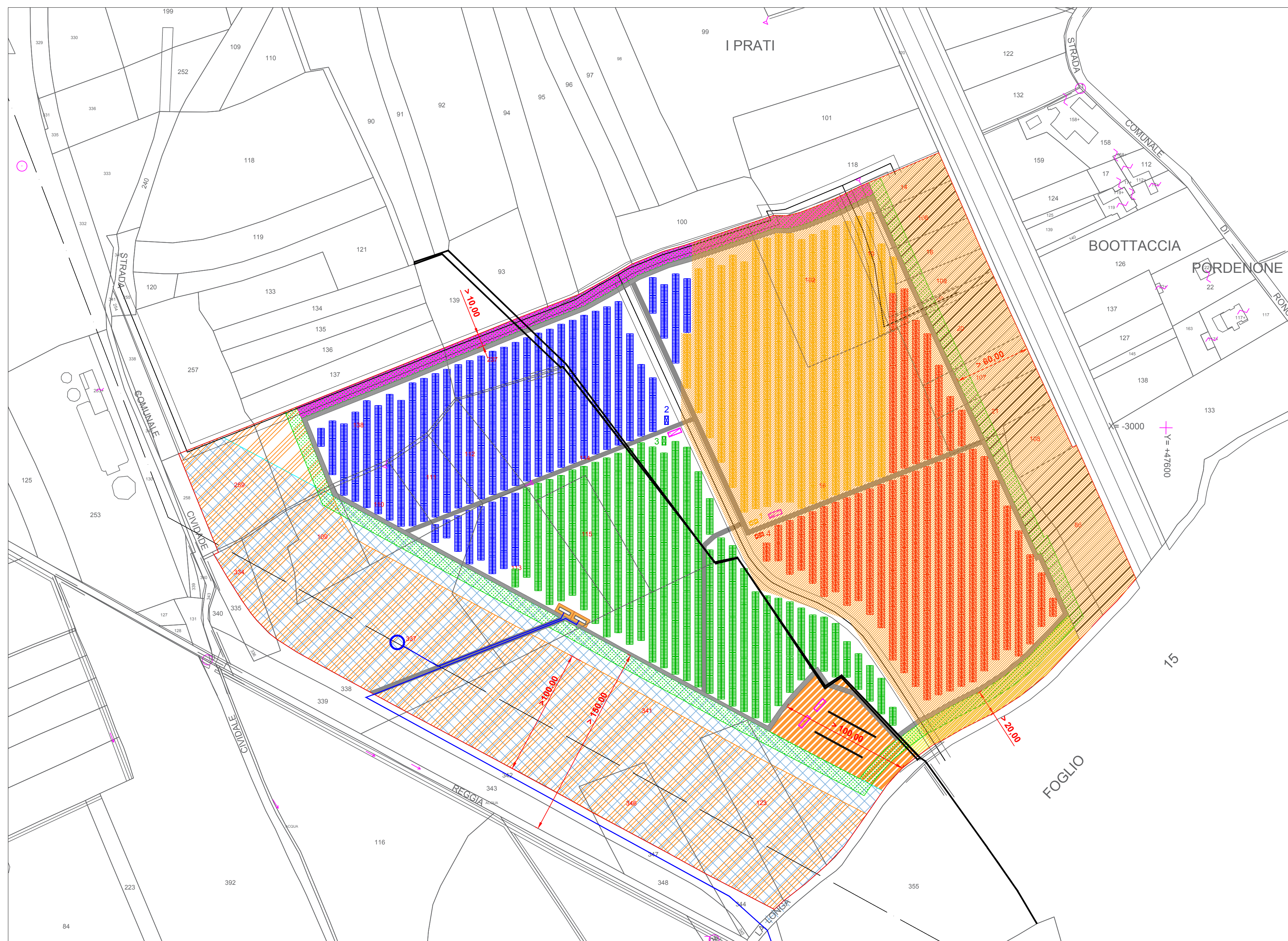
PLANIMETRIA CAMPO AGRIVOLTAICO E VINCOLI " BICINICCO 1" - Scala 1:2.000
