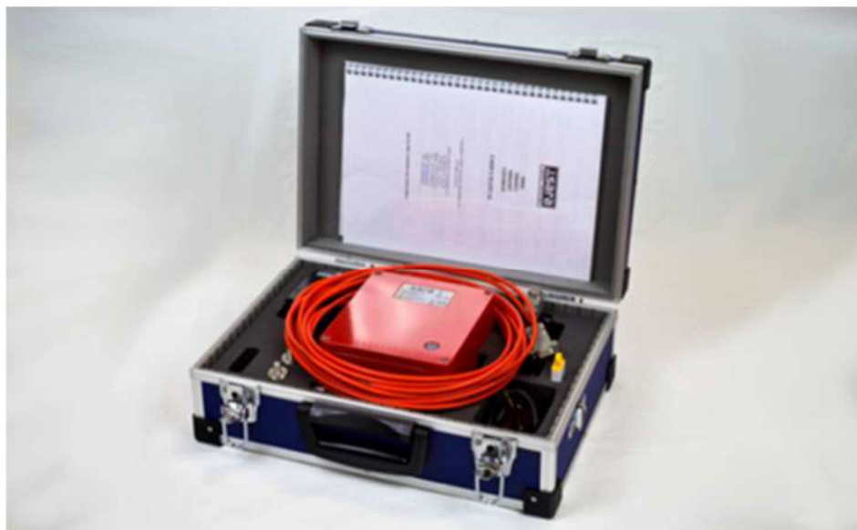
Figura 1: Strumentazione utilizzata per le misure di microtremore
