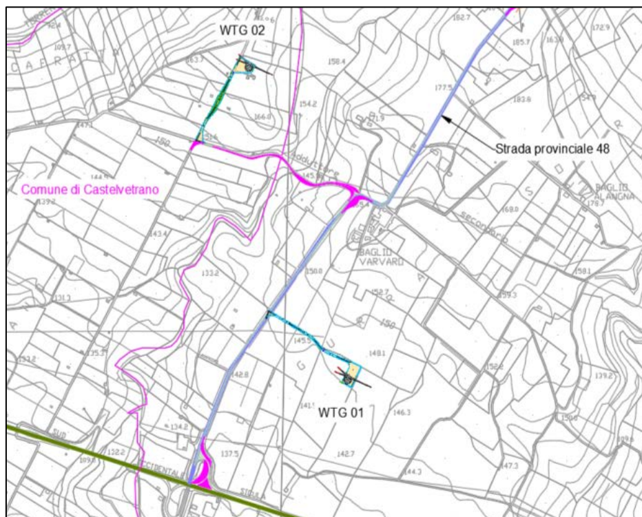
Figura 1.6.1 - Accessibilità al sito aerogeneratori WTG01 e WTG02
