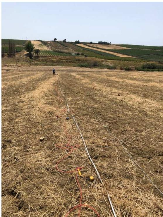
Foto Stendimento di sismica a rifrazione Rz7 e Mw7.
