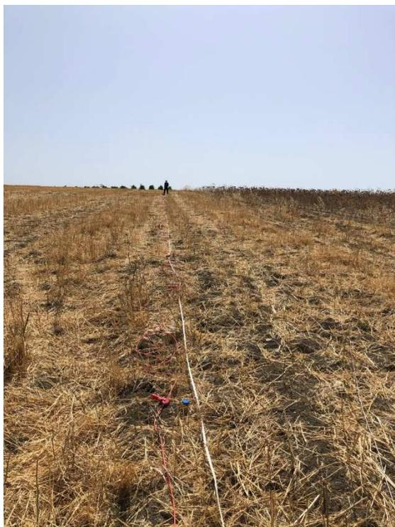
Foto Stendimento di sismica a rifrazione Rz8 e Mw8.
