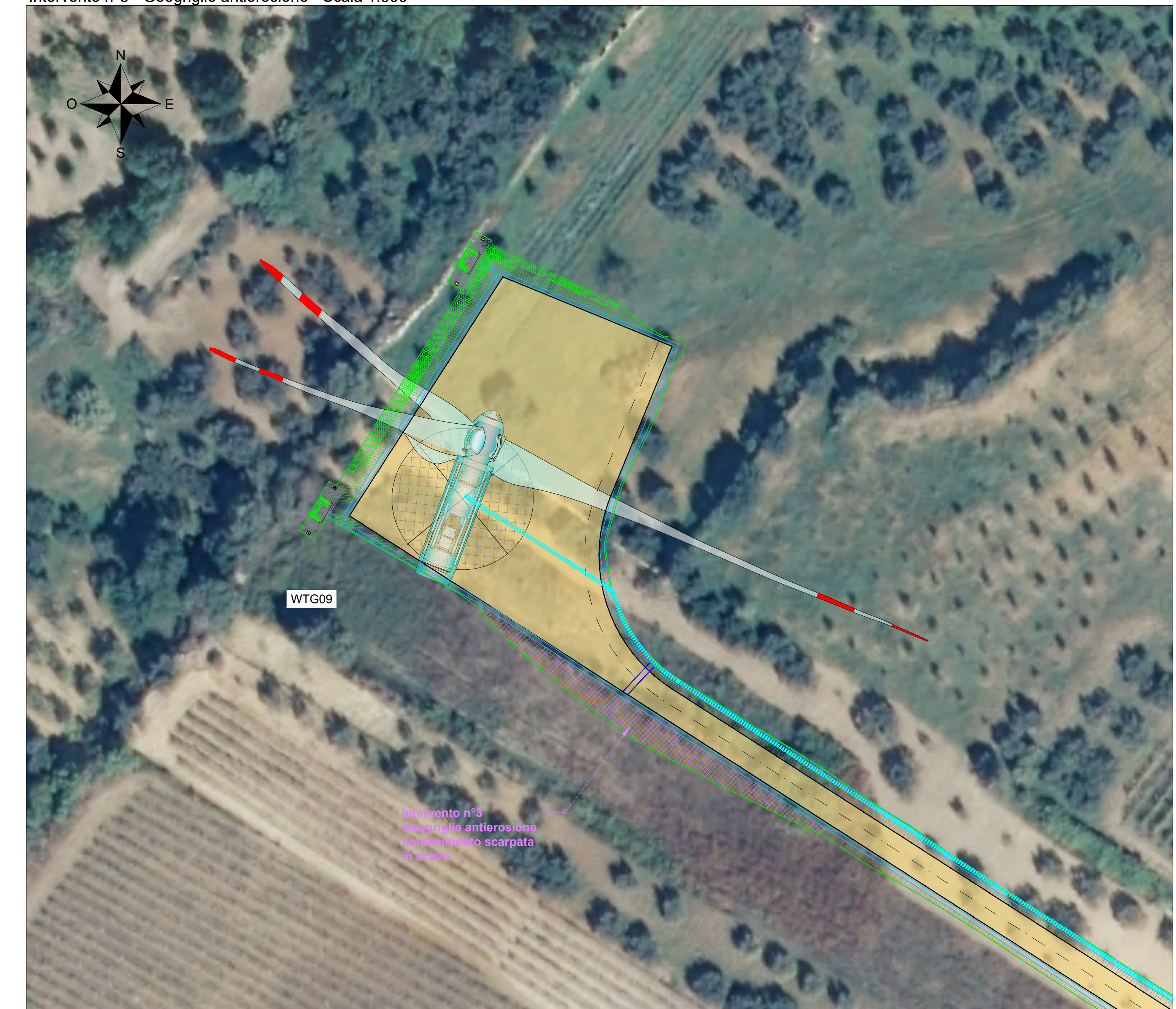
Intervento n°3 - Geogriglie antierosione - Scala 1:500
