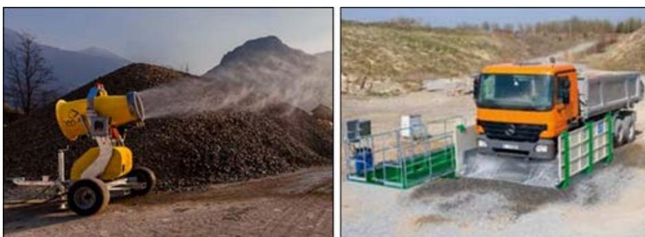
Esempio di Impianto di nebulizzazione mobile (immagine a sx) e di lavaggio ruote (immagine a dx).
