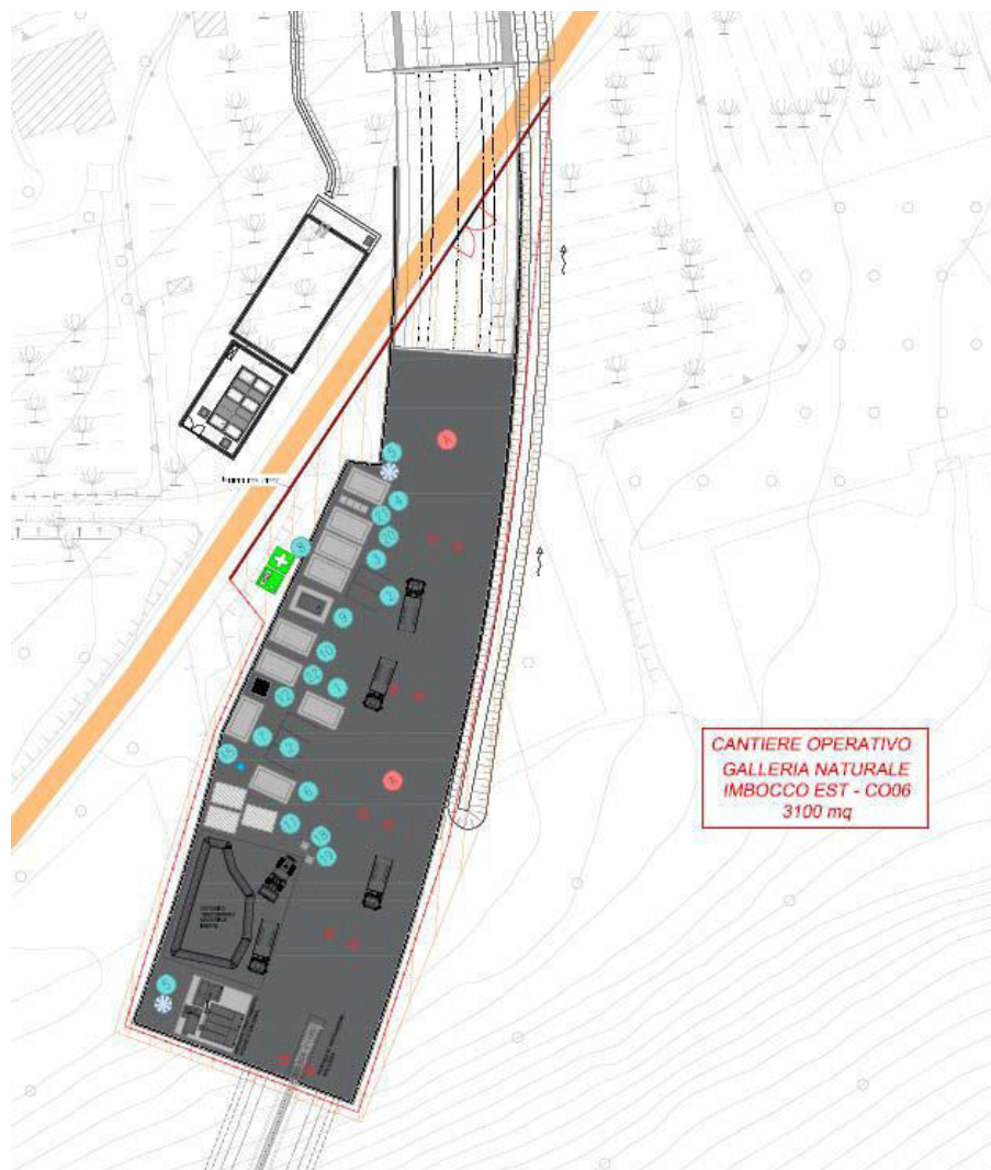
Figura 25. Area Cantiere Operativo Galleria Naturale Imbocco Est
