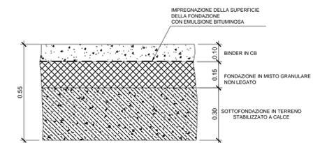
IMPERMEAZIONE DELLA SUPERFICIE DELLA FONDAZIONE CON EMULSIONE BITUMINOSA
