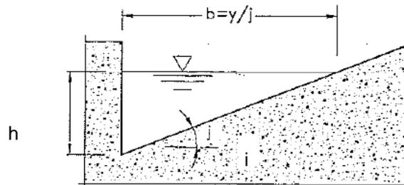
FIGURA 7.2 - SEZIONE TIPICA DI UNA BANCHINA LATERALE.
